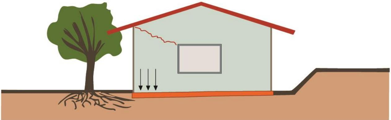
Figura 40: Recalque por solapamento de base de fundação
