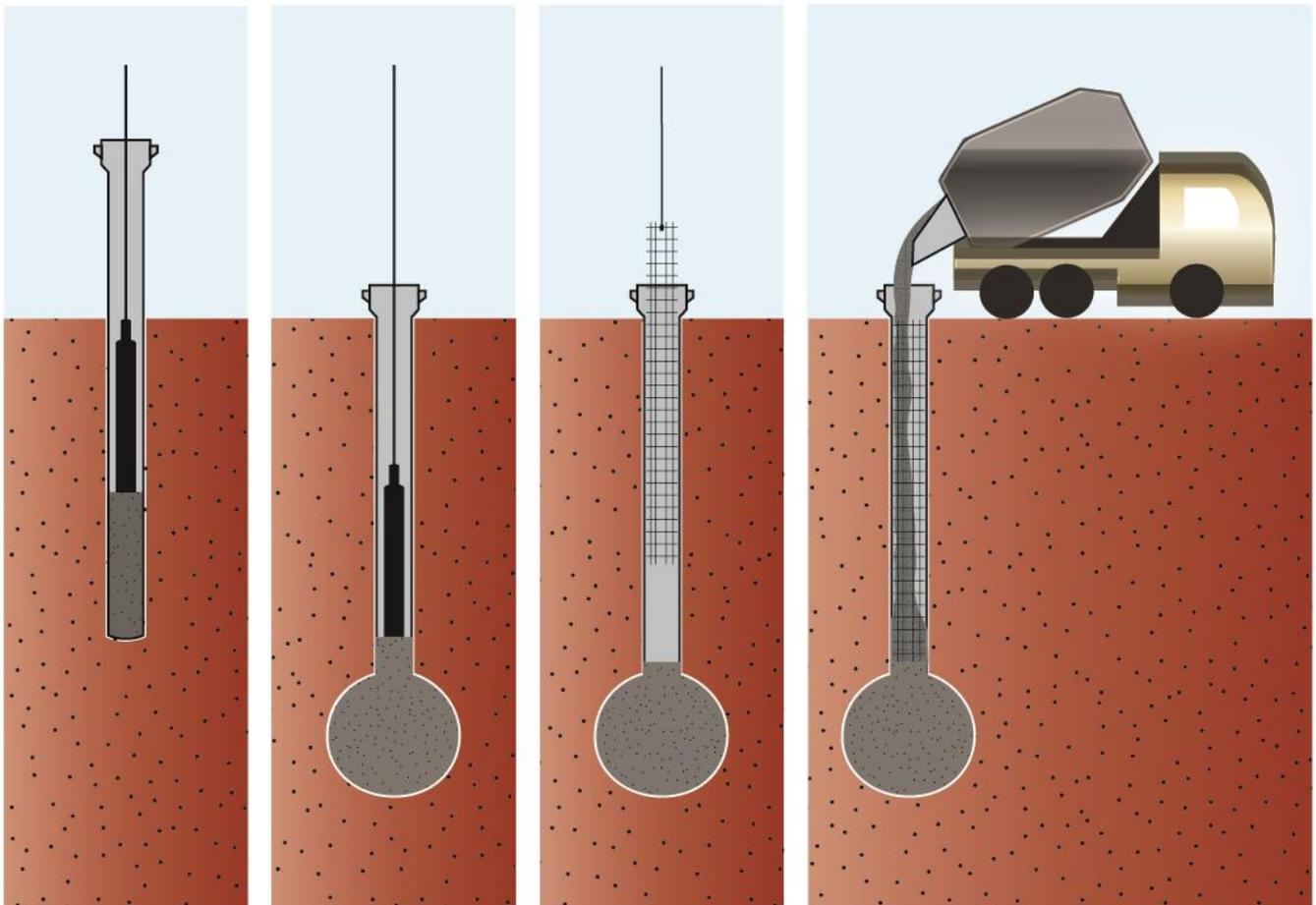
Figura 46: Estaca Franki, observe a ponta alargada
