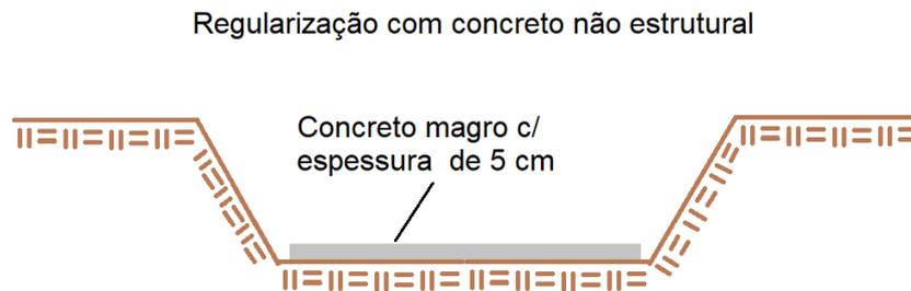
Figura 19: Lançamento do concreto de regularização.
