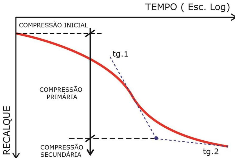
Figura 33: Curva típica de Tempo-recalque em um adensamento
