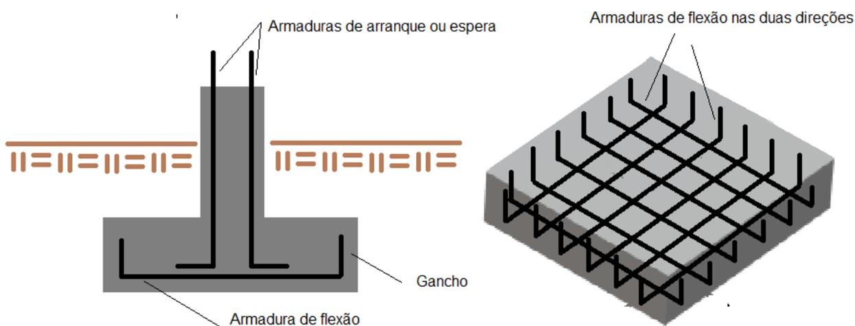
Figura 17: Armaduras de flexão e arranque em sapatas.
