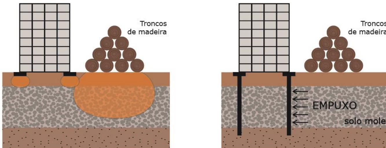
Figura 51: Efeitos de sobrecarga sobre diferentes fundações
