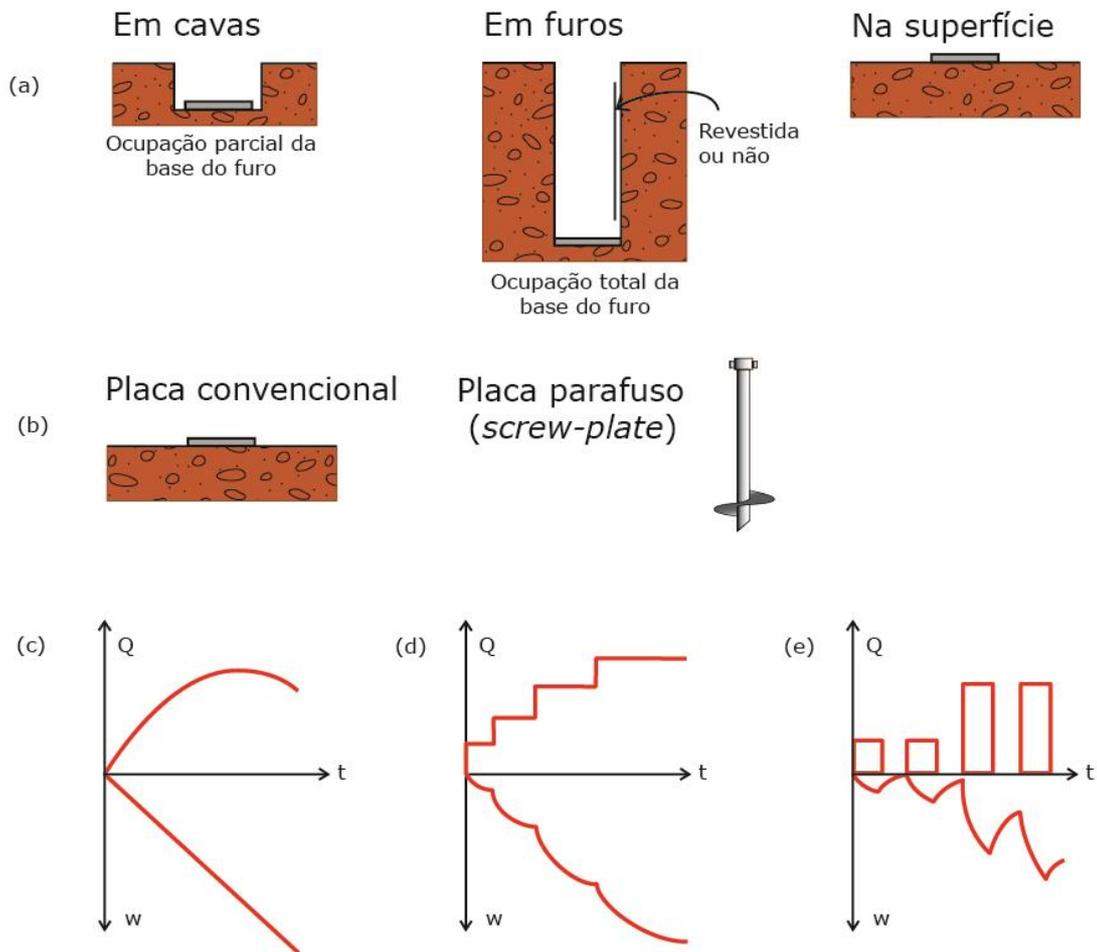
Figura 25: Os vários tipos de ensaios de placa
