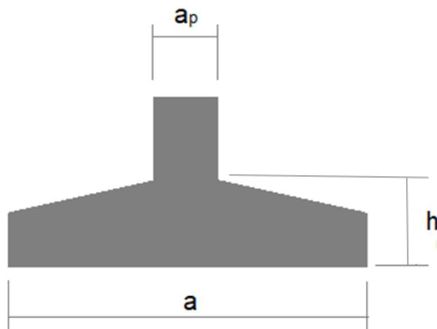
Figura 13: Variáveis a se considerar na análise quanto à rigidez de uma sapata.
