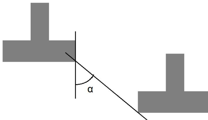
Figura 16: Ângulo vertical entre sapatas em cotas diferentes.
