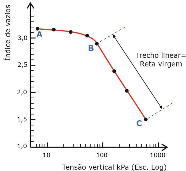
Figura 28: Gráfico obtido no ensaio de adensamento
