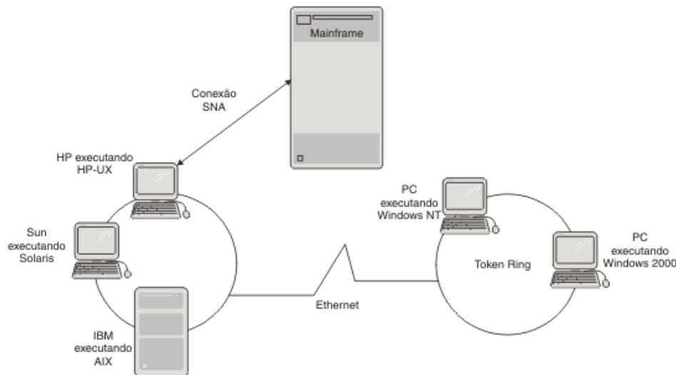
Esse sistema contém duas LANs conectadas entre si. Uma consiste em estações de trabalho UNIX (HP-UX, Solaris, AIX) de vários fabricantes (HP, Sun, IBM); já a outra consiste em PCs executando vários sistemas operacionais (NT e 2000) em Token Ring. Há uma LAN conectada a um mainframe por meio de uma conexão SNA. **Cliente/Servidor e P2P são exemplos famosos de arquitetura distribuída.**
