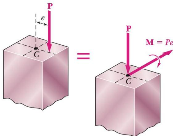
Para obter a tensão normal nesse caso, deve-se somar as tensões normais da carga centrada com as tensões de flexão geradas pelo momento, da seguinte forma.
