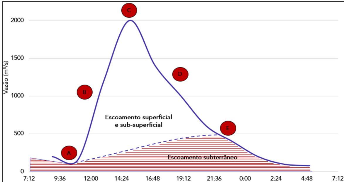
Um hidrograma típico apresenta apenas um pico de vazão, conforme ilustrado acima. No início (antes do ponto A), a água que precipita é infiltrada no solo, que ainda não se encontra saturado. Quando a capacidade de infiltração se igualar à taxa de precipitação (**ponto A**), a água começará a escoar superficialmente.
