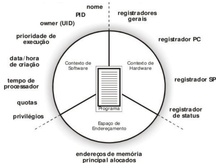
Existe uma estrutura de dados no núcleo do sistema operacional que serve para armazenar a informação necessária para tratar um determinado processo. Trata-se do **Bloco de Controle do Processo** (BCP, ou PCB - *Process Control Block*). Como o PCB possui informações críticas do processo ele deve ficar armazenado em uma área da memória protegida do acesso de usuários. Geralmente as informações contidas em um PCB incluem:
