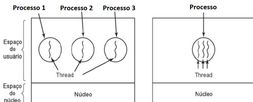
Geralmente as *threads* são divididas em duas categorias: thread ao nível do usuário e thread ao nível do *kernel* (núcleo). Quando falamos em *thread* ao nível de usuário queremos dizer que o controle das *threads*, o escalonamento entre elas, fica a cargo do espaço do usuário. Na figura a seguir podemos ver que a tabelas dos processos fica no *kernel*, mas as tabelas das *threads* de cada processo ficam nos próprios processos.
