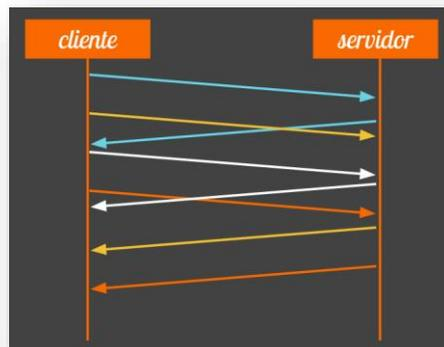
Diante do modelo proposto, o controle de fluxo em cada um desses streams é fundamental, devendo ser garantido esse aspecto. O HTTP2.0 utiliza o quadro WINDOW\_UPDATE para tal funcionalidade. Ele pode ser aplicado tanto para controle de fluxo de cada stream como da conexão como um todo.
