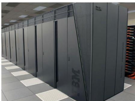
**I. Mainframe:** é um computador de grande porte, que possui alta capacidade de processamento e armazenamento de dados. O termo mainframe era utilizado para se referir ao gabinete principal que alojava a unidade central de processamento nos primeiros computadores. Anteriormente ocupavam um grande espaço e necessitavam de um ambiente especial para seu funcionamento, mas atualmente possuem o mesmo tamanho dos
