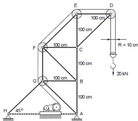
A força na barra BC, em kN, quando a carga é 20 kN, é igual a
