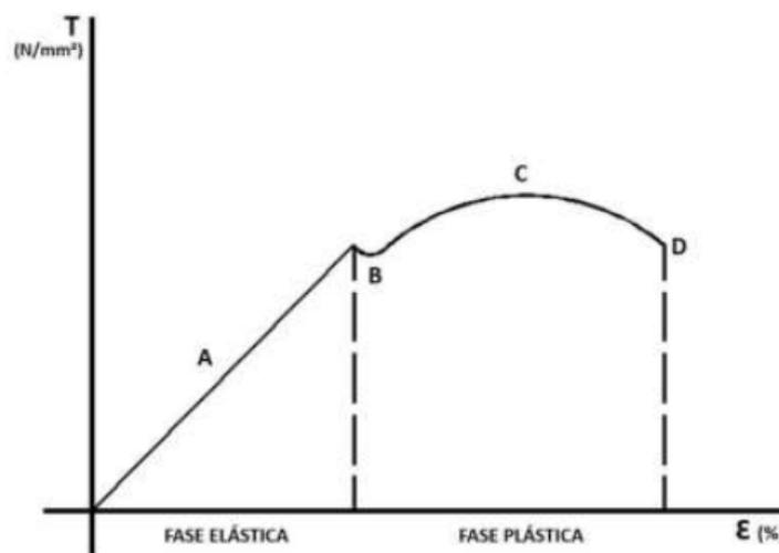
a) na fase elástica, se dividirmos a tensão pela deformação, em qualquer ponto, obtemos um valor constante. Este valor é chamado de módulo da elasticidade.
