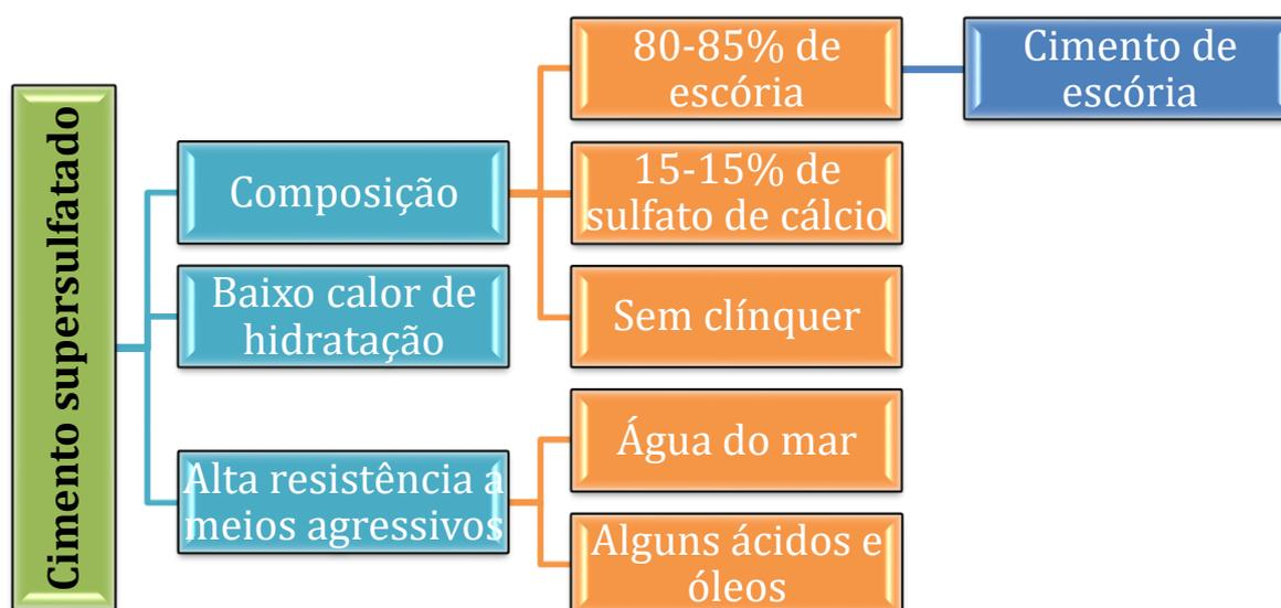
Figura 13: esquema do cimento supersulfatado
