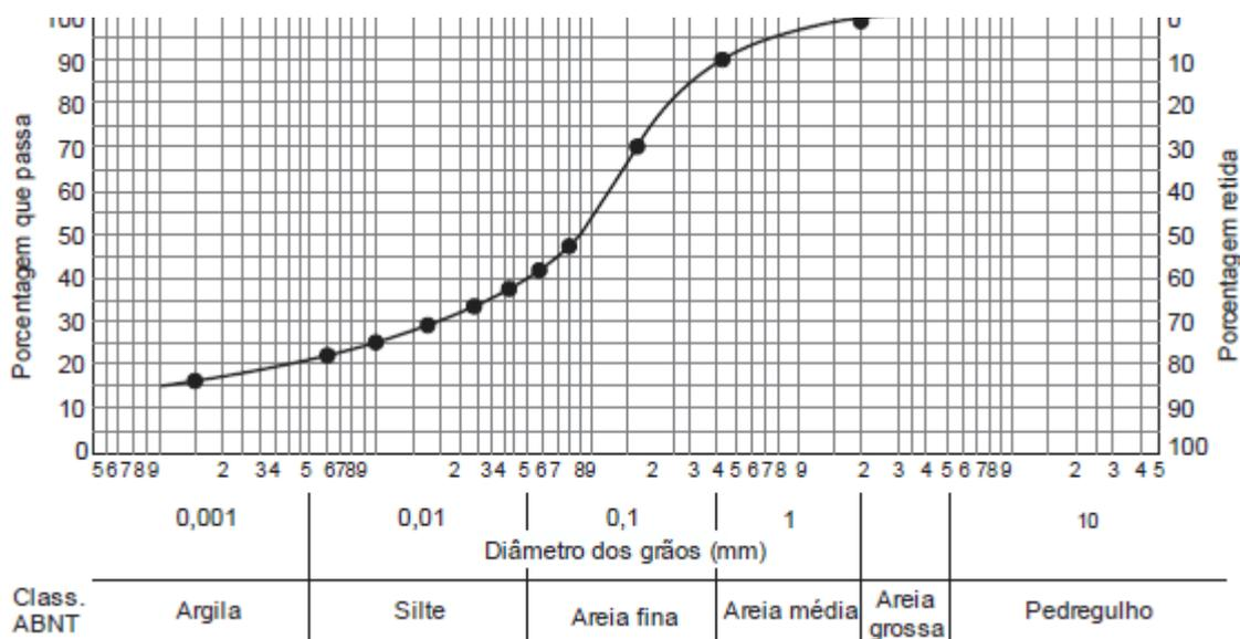
Figura 16: curva granulométrica, relacionando quantidades no eixo vertical e diâmetro das partículas no horizontal (FCC, 2013)
