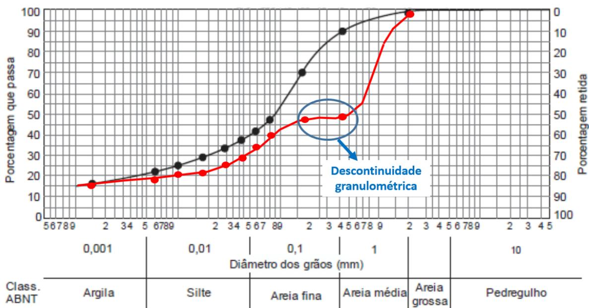
**Figura 19: curva granulométrica contínua (em preto) e descontínua (em vermelho). A curva descontínua tem muito mais probabilidade de resultar em um concreto que sofra facilmente segregação (FCC, 2013, adaptado)**
