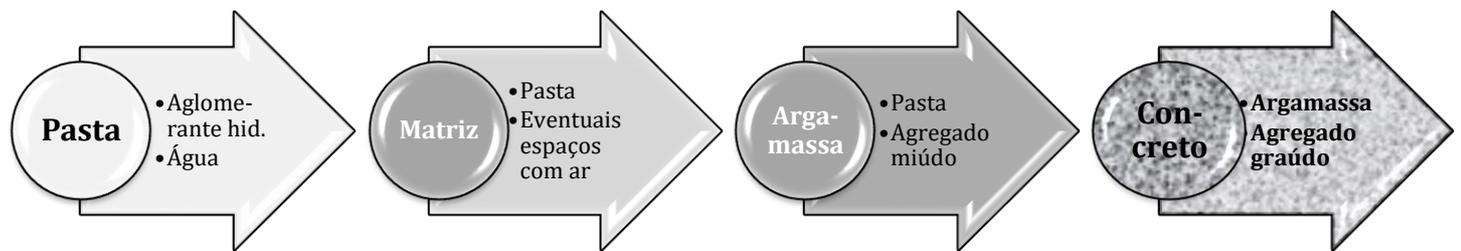
Figura 3: composição da pasta, argamassa e concreto
