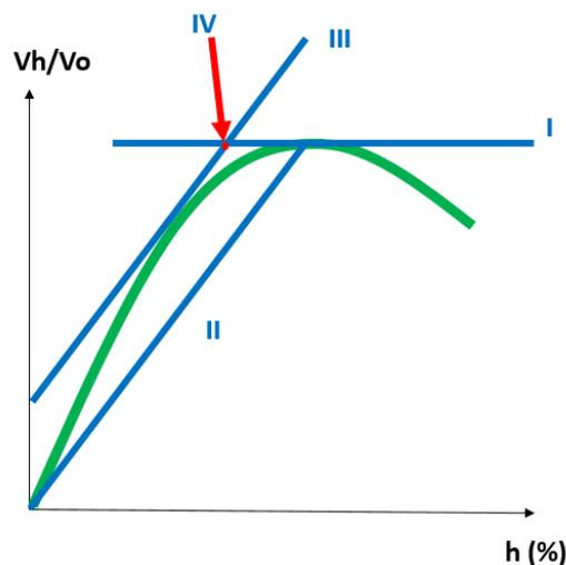
**Figura 20: gráfico para obtenção da umidade crítica**
