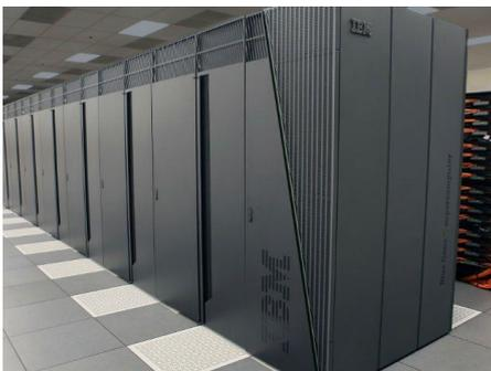
**I. Mainframe:** é um computador de grande porte, que possui alta capacidade de processamento e armazenamento de dados. O termo mainframe era utilizado para se referir ao gabinete principal que alojava a
