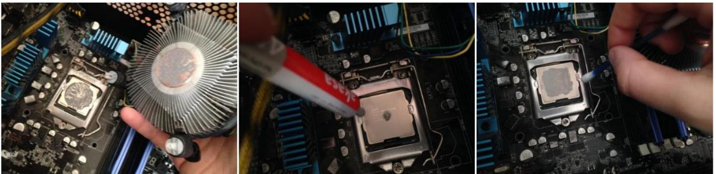
A principal função da pasta térmica é servir como condutor de calor e auxiliar em sua dissipação. Dessa forma, ela auxilia o *cooler* na hora de manter o processador a uma temperatura adequada. As melhores pastas possuem prata em sua composição, um ótimo condutor de calor.
