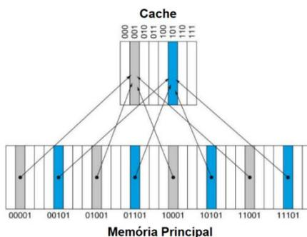
**Mapeamento associativo completo:** um bloco da memória principal pode ser carregado para qualquer linha do cache. Há a necessidade de escolher cuidadosamente qual deverá ser o bloco a ser substituído (políticas de substituição). Existe um campo *tag* incluído em cada linha. No exemplo abaixo podemos ver 16 blocos (*tags*) e em cada bloco há o byte 0 e o byte 1;
