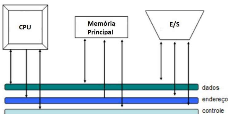
A figura é um resumo de um computador e nela encontramos a **memória principal** (representada basicamente pela memória RAM, mas não só por ela, como veremos), dispositivos de entrada/saída, incluindo a **memória secundária** (HDs, por exemplo) e, no processador (CPU) e também próximo a ele, encontramos a **memória cache** (aquela que melhora o desempenho, deixando o que é mais acessado mais próximo do processador).
