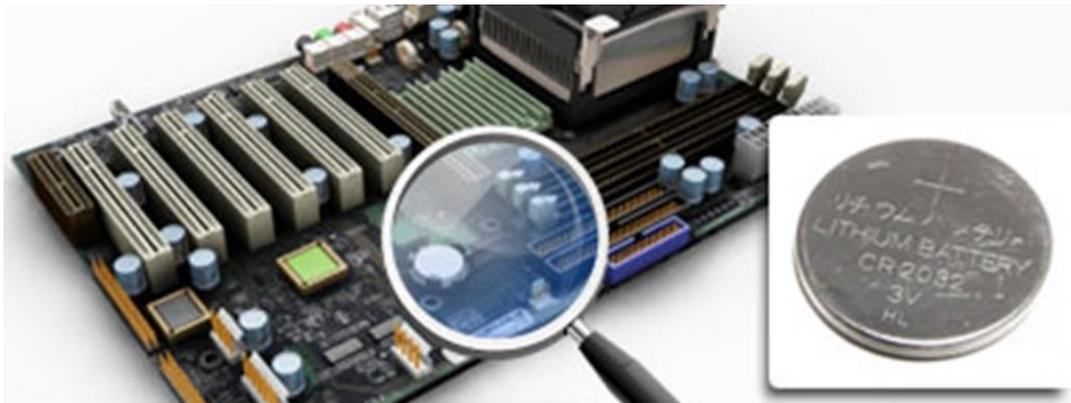
Essa bateria alimenta a memória CMOS (que guarda os dados de configuração usados no SETUP). Então, caso seja realizada a gravação de uma informação equivocada através do SETUP, causando algum erro de configuração do computador, é possível resolver o problema retirando a bateria da placa-mãe. Dessa forma será permitido que todos os dados sejam novamente inseridos após a reenergização do circuito.
