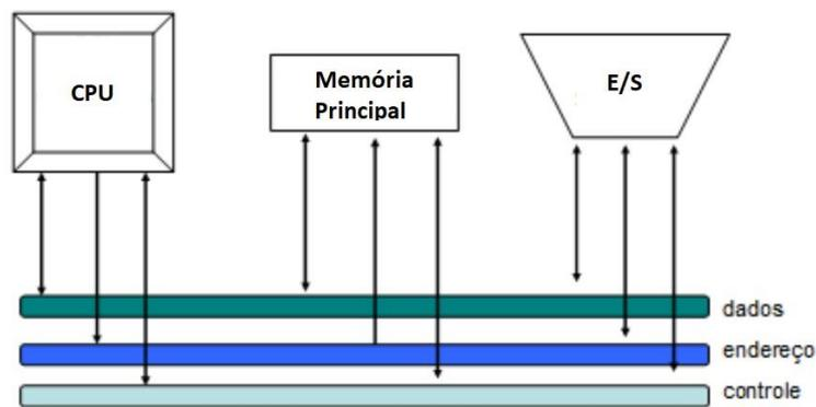
O desempenho do barramento é medido pela sua largura de banda (quantidade de bits que podem ser transmitidos ao mesmo tempo), geralmente potências de 2 (como quase tudo em informática): 8 bits, 16 bits, 32 bits, 64 bits etc. Também pela velocidade da transmissão, medida em bps (bits por segundo), ex.: 50 bps, 120 Kbps, 10 Mbps etc.
