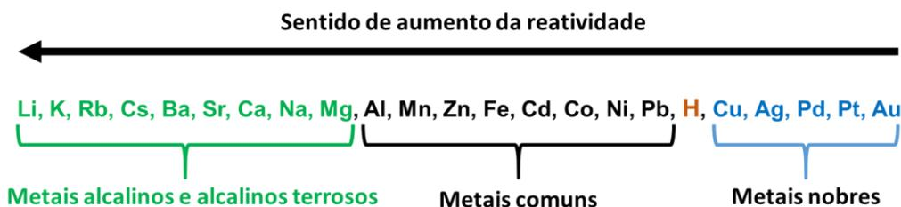
A reação que ocorre ao mergulharmos uma placa de zinco (Zn) em uma solução de sulfato de cobre (CuSO<sub>4</sub>) é um bom exemplo da reação de descolamento.
