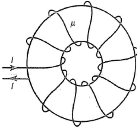
Observe que as espiras do fio estão enroladas compactadamente no núcleo e, portanto, a densidade de fluxo magnético está circunferencialmente orientada ao longo do núcleo conforme mostrado na figura a seguir.
