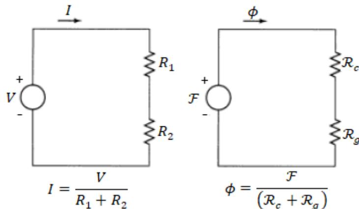
Figura 9-Analogia entre circuitos elétricos e magnéticos.
