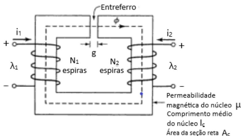
Figura 11-Circuito magnético com dois enrolamentos. Fonte: Fitzgerald (2006).
