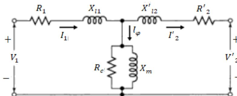
Figura 14-Circuito equivalente T de um transformador. Fonte: Fitzgerald (2006).
