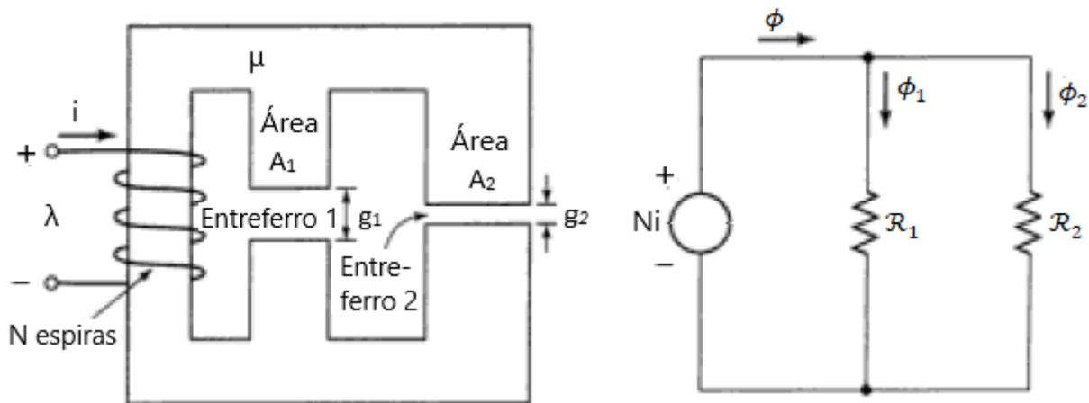
Figura 10-Circuito magnético e Circuito equivalente. Fonte: Fitzgerald (2006).
