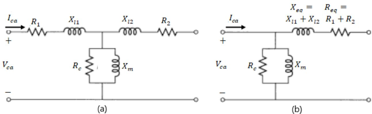
Figura 16-Circuito equivalente para ensaio a vazio. (a) Circuito equivalente T (b) Circuito equivalente L. Adaptado de: Fitzgerald (2006).
