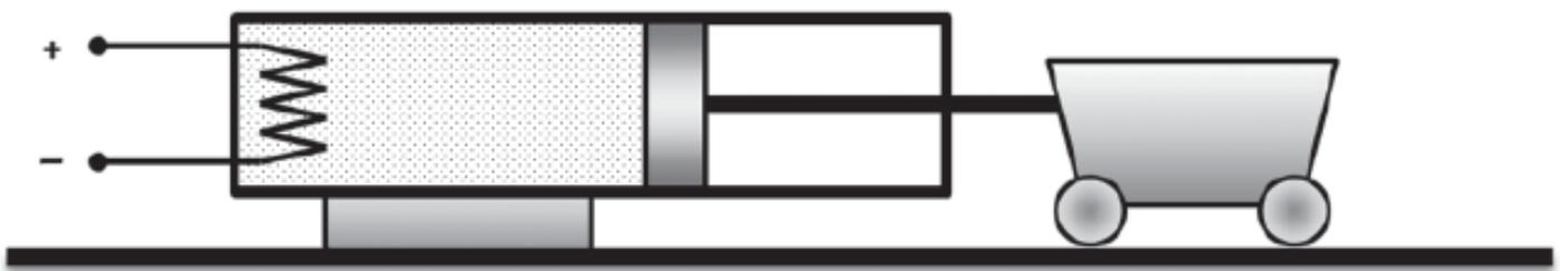
A área do pistão é  $20 \text{ cm}^2$ , e o carrinho, que é rigidamente ligado ao pistão, é deslocado sem oferecer qualquer resistência por  $15 \text{ cm}$  para a direita, quando o gás, perfeito por hipótese, localizado à esquerda do pistão, é aquecido. Durante o deslocamento, a pressão do gás é constante e igual a  $250 \text{ kPa}$ , e a variação de energia interna do gás é igual a  $18 \text{ J}$ . Nesse caso, a quantidade de calor, em joules, fornecida pela resistência é
