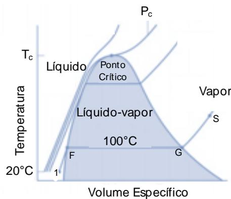
O ponto 1 no diagrama T-v indica o estado inicial da água líquida (a). Conforme o líquido é aquecido a sua temperatura aumenta até atingir o estado de líquido saturado a pressão específica representado por f. A linha 1-f representa os estados de líquidos e em alguns casos recebe o nome de estados de líquido sub-resfriado e também são denominados de estados de líquido comprimidos.
