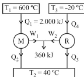
A figura acima mostra esquematicamente a configuração de uma máquina térmica reversível combinada que opera pelo ciclo de Carnot entre 600 °C e 40 °C. O motor térmico aciona um refrigerador
