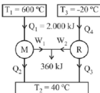
A figura acima mostra esquematicamente a configuração de uma máquina térmica reversível combinada que opera pelo ciclo de Carnot entre 600 °C e 40 °C. O motor térmico aciona um refrigerador
