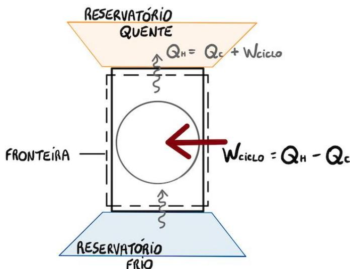
As transferências de energia ocorrem conforme indicado pelas setas, portanto, conforme a lei de conservação de energia, o **ciclo descarrega a energia ao reservatório quente  $Q_H$ , sendo esta igual a energia recebida pelo corpo frio somada ao trabalho líquido**. Esse pode ser tanto um ciclo de refrigeração, quanto um ciclo de bomba de calor, caso sua função seja remover energia do reservatório frio ou fornecer energia ao reservatório quente.
