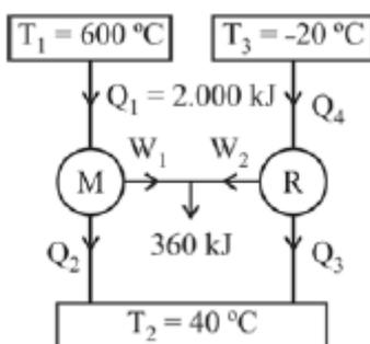
A figura acima mostra esquematicamente a configuração de uma máquina térmica reversível combinada que opera pelo ciclo de Carnot entre 600 °C e 40 °C. O motor térmico aciona um refrigerador reversível que opera entre 40 °C e -20 °C. A energia transferida ao motor é igual a 2.000 kJ e o trabalho líquido realizado pela máquina combinada motor/refrigerador é igual a 360 kJ.
