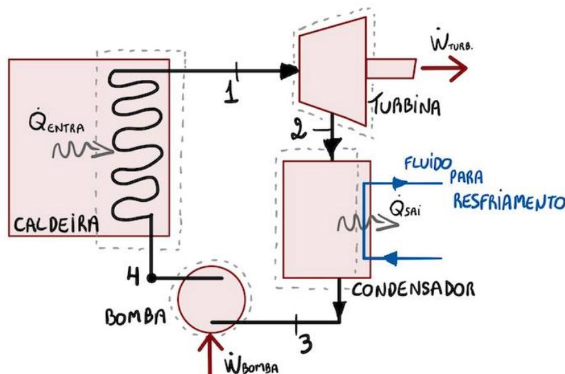
Há duas entradas de energia no ciclo, sendo uma de trabalho na bomba e outra de calor na caldeira.
