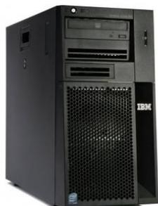
**II. Servidor:** é um software ou computador, que de forma centralizada fornece serviços a uma rede de computadores de médio e grande porte, chamada de cliente (arquitetura cliente-servidor). Podem desempenhar diversas funções, como armazenamento de arquivos, sistema de correio eletrônico (e-mail), serviços Web (exemplo: sites), segurança (exemplo: proxy e firewall), banco de dados, e muitas outras. O sistema operacional dos servidores é apropriado para as funções exercidas, como alta
