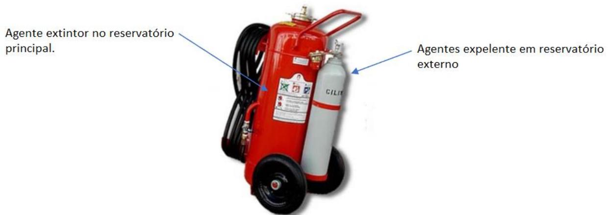
**Figura 1.3:** extintor sobre rodas com carga de água, de pressurização indireta.
