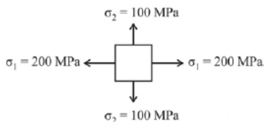
Um componente estrutural fabricado em aço dúctil está submetido a um estado plano de tensões, representado, em determinado ponto, pelo elemento de tensões mostrado na figura acima, em que  $\sigma_1 = 200 \text{ MPa}$  e  $\sigma_2 = 100 \text{ MPa}$ . Considerando a possibilidade de falha por escoamento, julgue o item abaixo, a respeito da resistência ao escoamento do material do referido componente.
