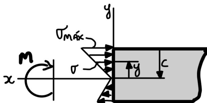
Analogamente para se determinar a tensão normal a uma distância intermediária ( $\gamma$ ), podemos calcular está a partir da seguinte equação:
