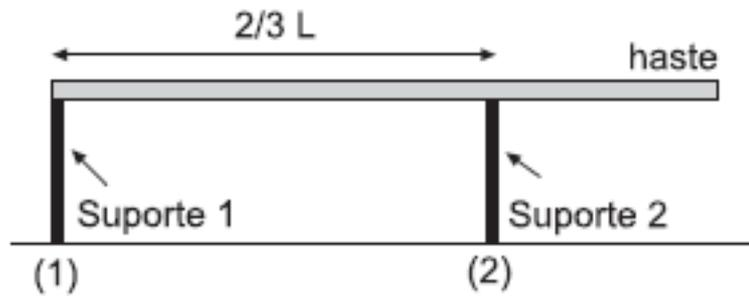
Uma haste homogênea de massa 50,0 kg é colocada horizontalmente sobre dois suportes, conforme mostra a figura.
