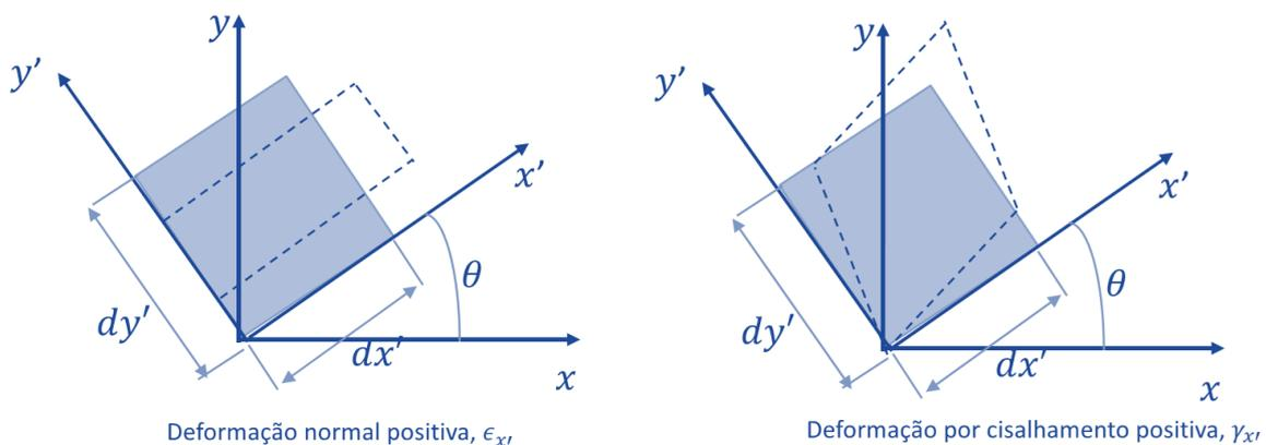
Visto isso, analogamente a tensão no plano, podemos afirmar que se um **estado de deformação em um ponto for conhecido**, de acordo com uma orientação determinada de um elemento do material, **podemos determinar** o estado de deformação **para uma orientação diferente** através das seguintes equações:
