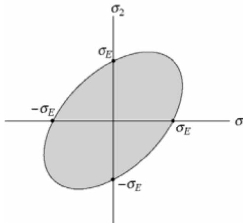
Quando um ponto do material estiver tracionado da maneira que a coordenada da tensão ( $\sigma_1, \sigma_2$ ) esteja posicionada no limite ou fora da área sombreada, diz-se que o material falhou.
