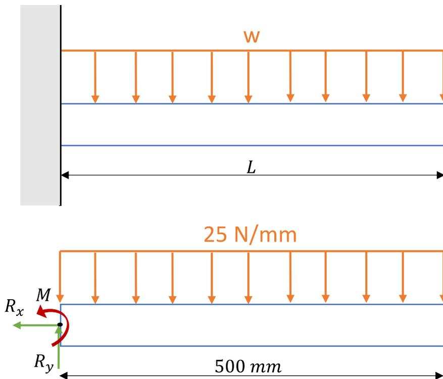
A **força resultante da concentração** de uma força distribuída em uma viga sempre estará localizada no **centróide** da área em consideração. Neste caso temos um retângulo que possui seu centróide no centro de seu comprimento que é  $250 \text{ mm}$ . Além disso, a resultante é igual a carga distribuída multiplicada pelo seu comprimento. Vejamos:
