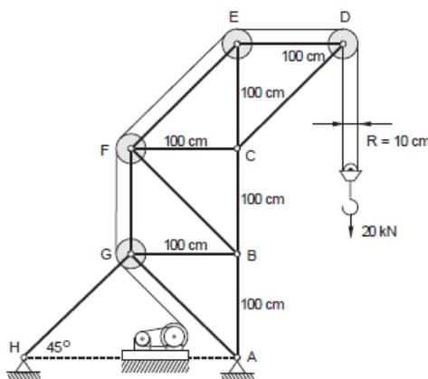
A força na barra BC, em kN, quando a carga é 20 kN, é igual a
