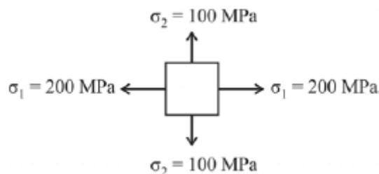
Um componente estrutural fabricado em aço dúctil está submetido a um estado plano de tensões, representado, em determinado ponto, pelo elemento de tensões mostrado na figura acima, em que  $\sigma_1 = 200$  MPa e  $\sigma_2 = 100$  MPa. Considerando a possibilidade de falha por escoamento, julgue o item abaixo, a respeito da resistência ao escoamento do material do referido componente.
