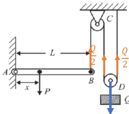
Após o DCL, podemos aplicar o somatório de momentos em relação ao ponto A na viga AB, sendo esse igual a zero para que ela permaneça na horizontal e assim encontramos a expressão para determinação de x.
