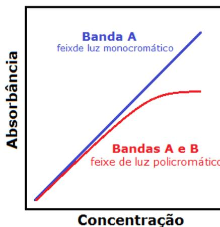
**Luz espúria:** é a radiação fora do comprimento de onda escolhido para análise. Essa radiação indesejada é oriunda de reflexões dos componentes ópticos do equipamento (redes de difração, lentes, espelhos, filtros ou janelas). Se a luz espúria, que é um interferente, estiver presente, então chegará mais luz no detector, provocando uma diminuição na absorbância. Ou seja, a absorbância aparente (observada) será menor que a absorbância real.
