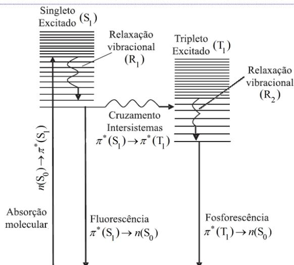
**Transições eletrônicas radioativas e não radioativas que explicam os fenômenos fluorescência e fosforescência** (Adaptado de GOUVÊA, Marcos M. et al. *Aplicação da radiação ultravioleta como forma de contribuição para a química verde e construção de um reator fotoquímico alternativo e de baixo custo, para pré-tratamento de amostras. Química Nova*, v. 37, n. 2, p. 337-343, 2014).
