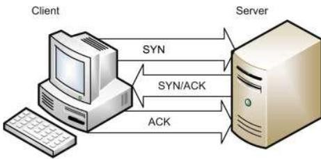
Para estabelecer a conexão entre uma máquina A e uma máquina B, a máquina A envia um segmento de controle chamado SYN (que é como se fosse um "Alô"); a máquina B envia de volta outro segmento de controle chamado SYN/ACK (que é como se fosse um "Alô" de resposta); então a máquina A envia outro segmento de controle chamado ACK. Pronto... conexão estabelecida!
