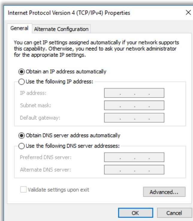
O Servidor DHCP recupera essas informações, configura a rede e aloca um endereço lógico dinâmico para a máquina cliente. Ao terminar a conexão, ele desaloca o endereço lógico para permitir que ele possa ser utilizado por outro cliente em uma nova conexão. **Logo, esse protocolo é capaz de atribuir uma alocação dinâmica de endereços lógicos (entre outras configurações) de forma automática.**
