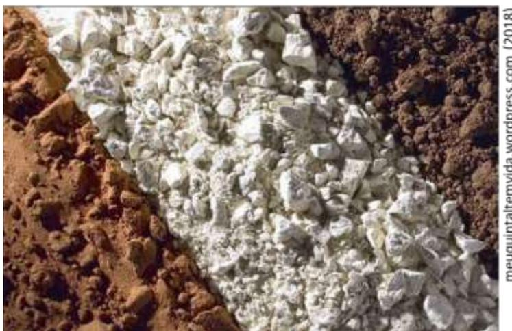
Três tipos de solo dispostos paralelamente para evidenciar a diferença de coloração que é decorrente de suas composições químicas divergentes.
