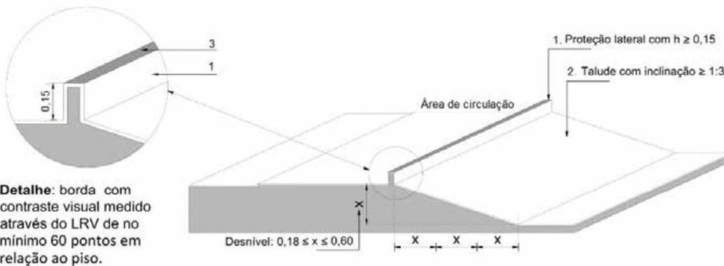
**Detalhe:** borda com contraste visual medido através do LRV de no mínimo 60 pontos em relação ao piso.
