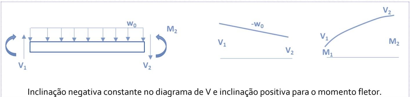
Inclinação negativa constante no diagrama de V e inclinação positiva para o momento fletor.
