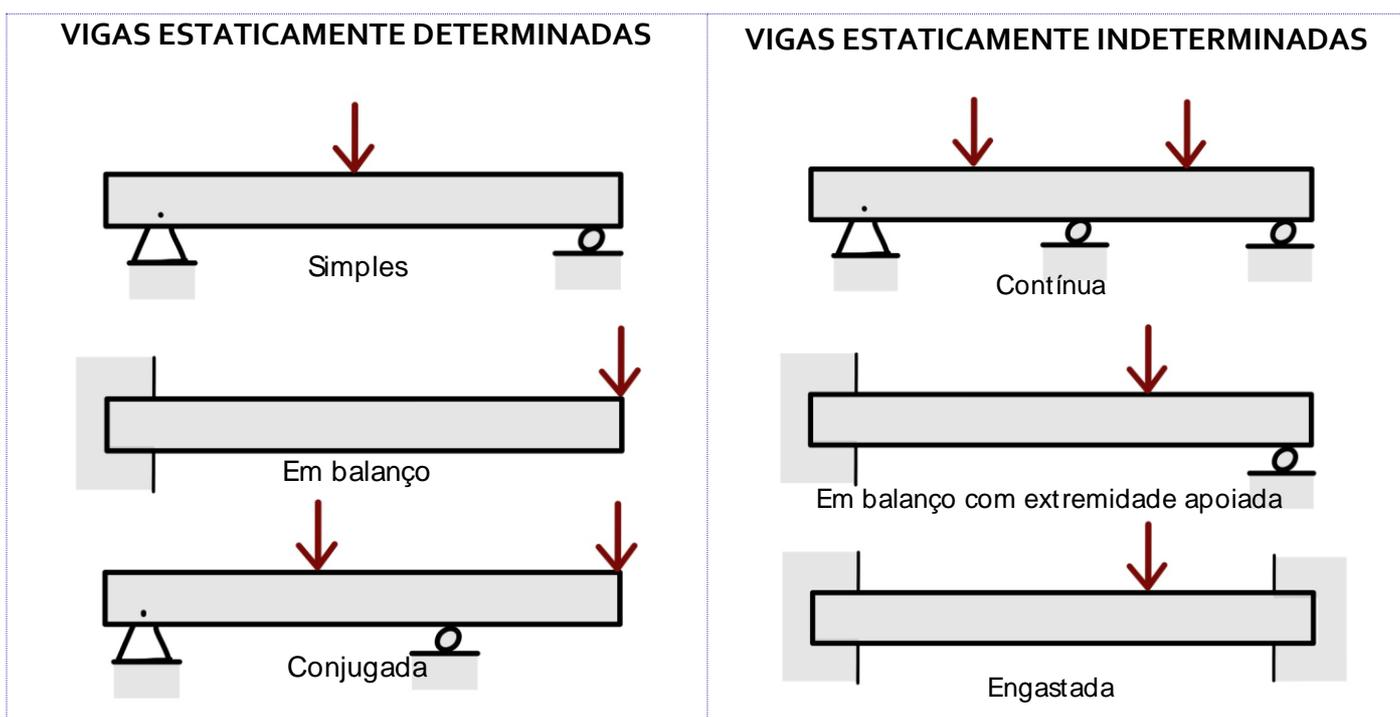
Podemos também identificar as vigas pelos **tipos de carregamentos externos** a qual estão expostas. Estas podem sofrer cargas concentradas, como vistas na figura acima ou distribuídas, conforme a figura abaixo.
