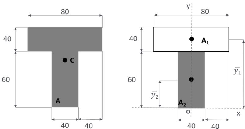
Para determinarmos o **centróide** da área indicada, devemos adotar o **eixo de coordenadas** e dividi-la em dois retângulos. Conforme a figura ao lado.
