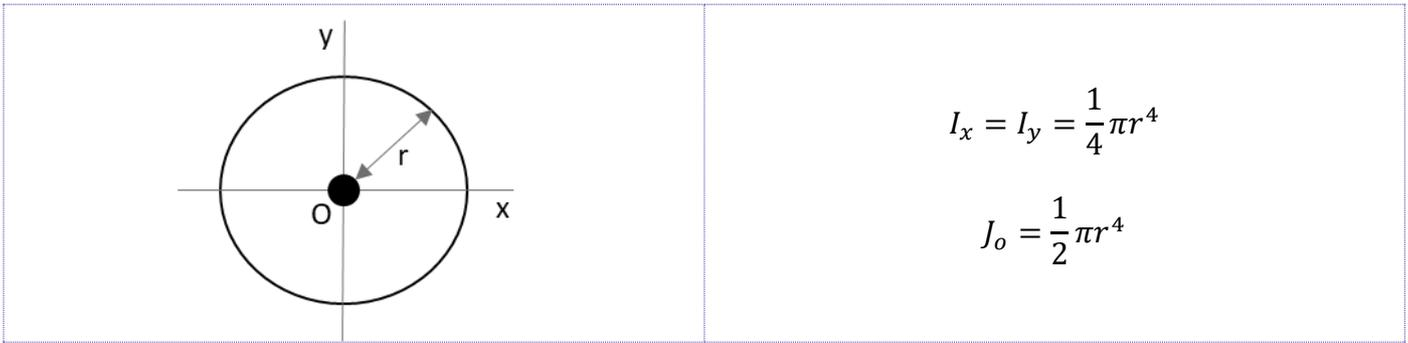
Se o momento de inércia de uma área situada em torno de um eixo centroide for conhecido, é possível determinar o momento de inércia da área em torno de um **eixo paralelo** correspondente através do **TEOREMA DOS EIXOS PARALELOS**. Esse teorema é muito utilizado na hora de calcularmos o momento de inércia de **áreas compostas**. As equações que definem o teorema dos eixos paralelos são:
