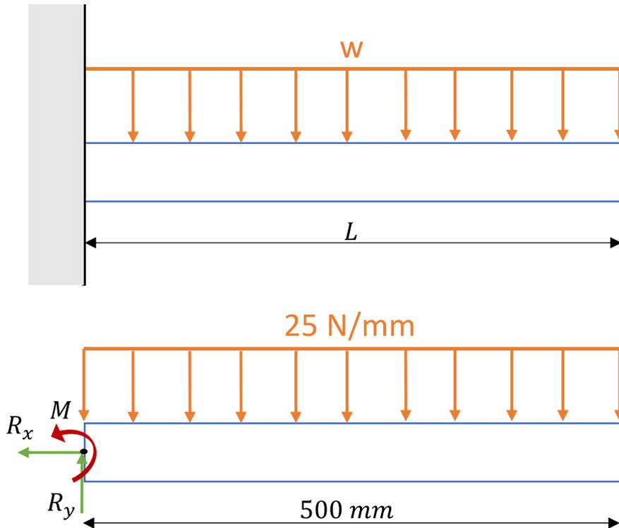
A **força resultante da concentração** de uma força distribuída em uma viga sempre estará localizada no **centróide** da área em consideração. Neste caso temos um retângulo que possui seu centróide no centro de seu comprimento que é 250 mm. Além disso, a resultante é igual a carga distribuída multiplicada pelo seu comprimento. Vejamos:
