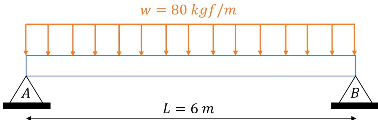
As reações nos apoios correspondem a metade do carregamento aplicado devido a simetria na viga, assim...
