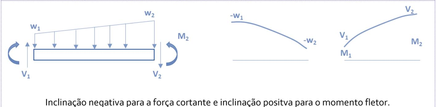
Inclinação negativa para a força cortante e inclinação positiva para o momento fletor.
