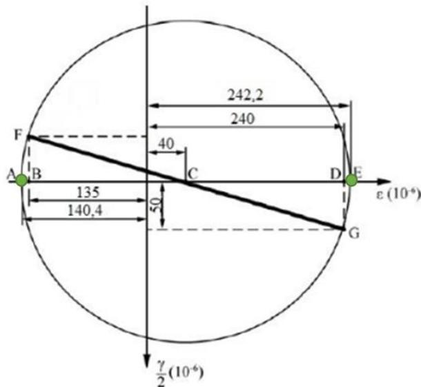
Podemos notar que no círculo de Mohr da questão as deformações principais máxima e mínima são dadas respectivamente pelos pontos E e A, respectivamente. Portanto, adotando a correta convenção de sinal para deformação positiva a direita do eixo das ordenadas e negativa a esquerda, a **alternativa B** está **CORRETA** e é o gabarito da questão.
