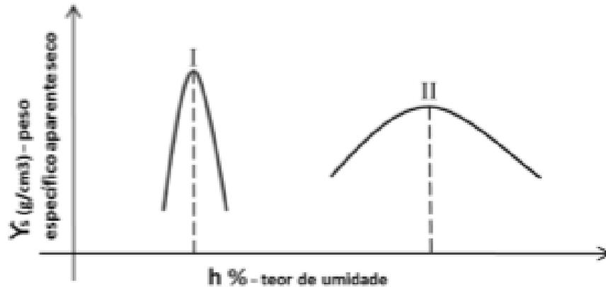
Os gráficos conceituais mostrados, obtidos após a execução de ensaios de compactação levados a efeito pelo laboratorista da obra, indicam as características dos solos utilizados.
