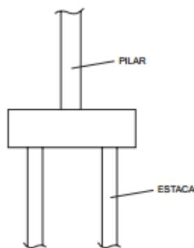
O elemento que faz a ligação entre o pilar e as estacas, distribuindo convenientemente as cargas, é o (a):
