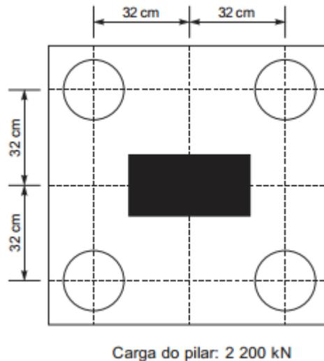
Após a realização de prova de carga sobre placa chegou-se aos valores de 750 kN e 1100 kN para 15 mm de recalque e 47,5 mm (ruptura), respectivamente. Sabendo-se que, o recalque estrutural admissível é de 15 mm, pode-se afirmar que o projeto de estaqueamento do pilar está
