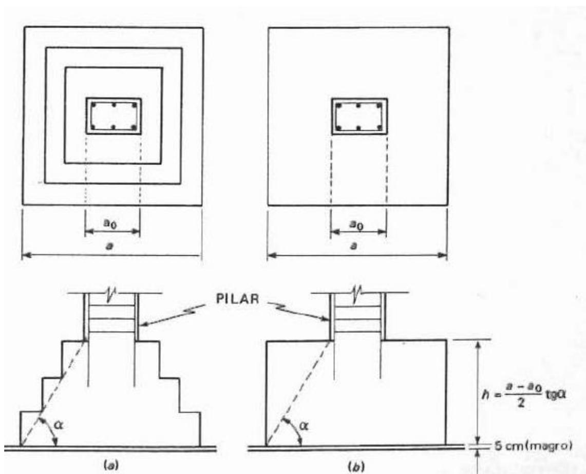
Não confundir blocos de fundação com **blocos de coroamento** ou de capeamento, os quais são construídos sobre estacas ou tubulões, e são armados de modo a **transmitir a carga dos pilares para os elementos da fundação profunda**.
