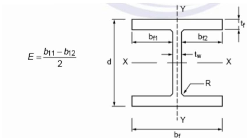
No caso de peças reutilizadas, deve ser verificada a seção real mínima da peça. **A redução de área da seção transversal**, em qualquer ponto da estaca, **deve ser de no máximo 20 % do valor nominal da peça nova**. A carga admissível ou a força resistente de cálculo deve ser fixada após análise dos aspectos geotécnicos de transferência de carga para o solo.
