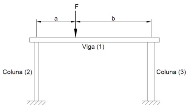
O perito verificou que as deformações das colunas são inteiramente elásticas e lineares, sendo expressas pelo quociente da variação do comprimento pelo comprimento inicial. Em condições de equilíbrio estático, desprezando o peso da estrutura e considerando que a viga está submetida somente pela ação da força F, o perito realizou diversas análises, alterando a posição da força aplicada, chegando à seguinte conclusão:
