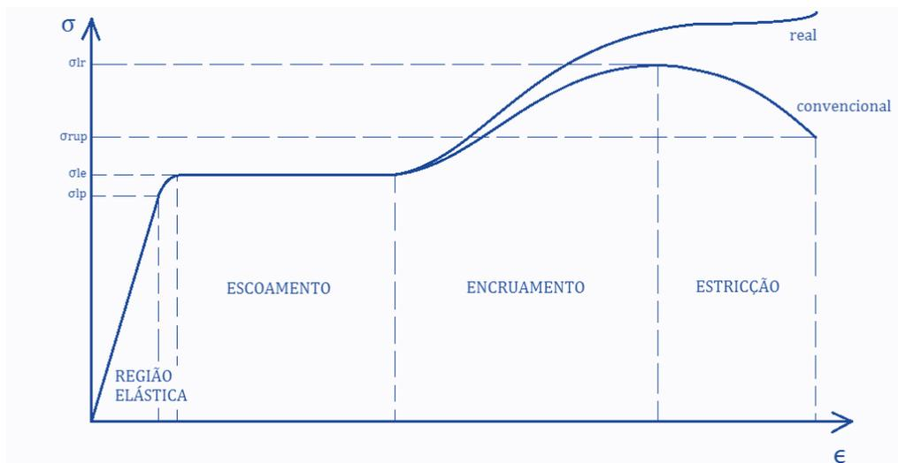
Quando se é calculado os valores de tensão e deformação a partir da área da seção transversal e o comprimento do corpo de prova no instante em que a carga é medida a obtemos a curva tensão X deformação real exemplificada na figura acima. Apesar de o diagrama de tensão-deformação convencional e real serem diferentes a maioria dos estudos e projetos são voltados dentro da região elástica do material.
