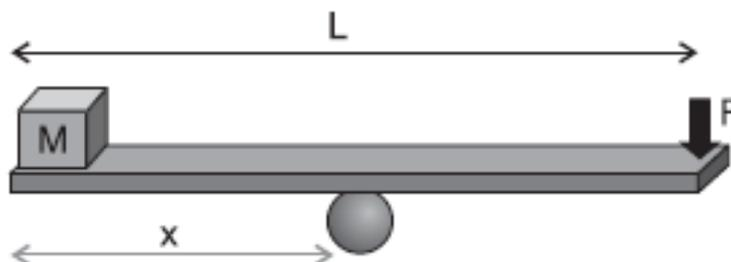
Uma prancha de madeira de massa desprezível e comprimento  $L = 2,8 \text{ m}$  é utilizada para manter em equilíbrio, na horizontal, um cubo pequeno de massa  $20,0 \text{ kg}$  ao realizar uma força  $F$  de  $80,0 \text{ N}$  em uma das extremidades da prancha.
