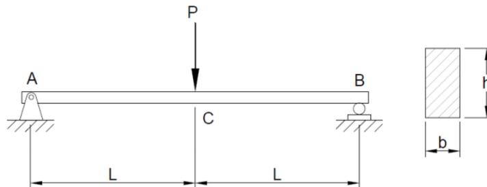
O momento de inércia ( $I$ ) da seção transversal retangular da viga de base  $b$  e altura  $h$ , em relação a um eixo que passa pelo seu centroide, é dado por  $I = (b \times h^3)/12$ . A intensidade da tensão de flexão máxima absoluta na viga é dada por  $\sigma_{max} =$
