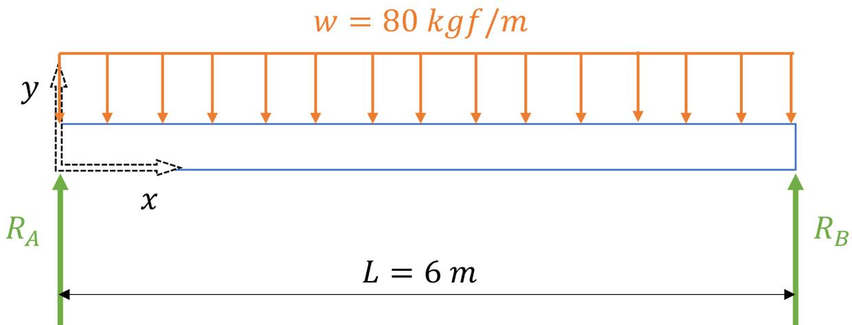
Adotando nosso sistema de referência com origem conforme a imagem de nosso DCL acima temos para nosso esforço cortante...
