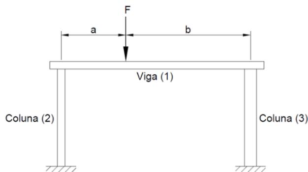
O perito verificou que as deformações das colunas são inteiramente elásticas e lineares, sendo expressas pelo quociente da variação do comprimento pelo comprimento inicial. Em condições de equilíbrio estático, desprezando o peso da estrutura e considerando que a viga está submetida somente pela ação da força F, o perito realizou diversas análises, alterando a posição da força aplicada, chegando à seguinte conclusão:
