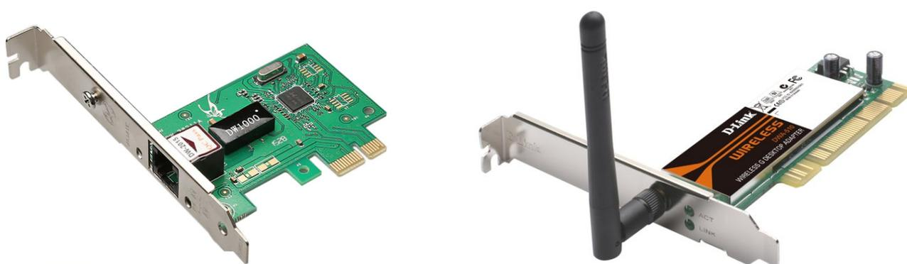
**Galera, essa é a famosa Placa de Rede<sup>7</sup>!** Se vocês olharem na parte de trás do gabinete de um computador, vocês a verão (provavelmente com o cabo azul de par trançado conectado a ela). Esse é o recurso de hardware geralmente instalado no computador para permitir uma comunicação bidirecional – transmissão e recebimento de dados – com os demais elementos da rede. Agora vejam que coisa interessante...
