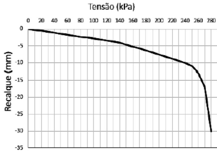
Figura 1 – Curva tensão-recalque
