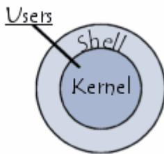
**Shell** - É a interface que funciona como intermediário entre o usuário e o sistema operacional. A sua função é ler a linha de comando digitada pelo usuário, interpretar seu significado, executar o comando e devolver o resultado pelas saídas. Na verdade, a interface Shell é um arquivo executável, encarregado de interpretar comandos, transmiti-los ao sistema e devolver resultados. Por este motivo foi escolhido o nome Shell, que é um
