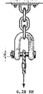
A manilha apresentada na figura acima suporta um cabo que tem aplicada uma força de 6,28 kN. Sabendo que a tensão de cisalhamento médio do pino (T) é igual a 40 Mpa, determine o diâmetro do pino (d) e assinale a opção correta.
