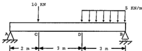
A figura acima mostra uma viga biapoada, com carga concentrada e distribuída. As reações  $R_A$  e  $R_B$ , nos apoios A e B, são, respectivamente:
