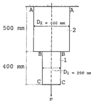
A figura acima representa uma barra de duas seções (1 e 2). As peças AB e BC são feitas de alumínio e possuem diâmetro  $D_2$  igual a 400 mm e diâmetro  $D_1$  igual a 200 mm. Sabendo que o alongamento total da peça é igual a 0,00700 mm, determine a carga F na peça e assinale a opção correta.
