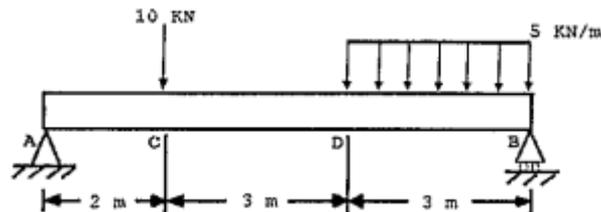
A figura acima mostra uma viga biapoiada, com carga concentrada e distribuída. As reações  $R_A$  e  $R_B$ , nos apoios A e B, são, respectivamente:
