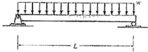
Para a viga biapoiada acima, sabendo que  $w$  e  $L$  são respectivamente iguais a  $2\text{ kN/m}$  e  $500\text{ mm}$ , determine o momento fletor máximo e assinale a opção correta.
