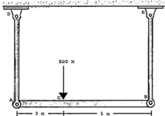
A figura acima mostra uma viga AB rígida com 8m de comprimento, carregada pela força de 500N no ponto C, e a viga é apoiada por duas hastes de aço. Sabendo que as áreas das seções transversais das hastes AD e BE são iguais, medindo  $250\text{mm}^2$ , determine as tensões nas hastes de aço AD e BE, respectivamente, e assinale a opção correta.
