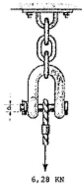
A manilha apresentada na figura acima suporta um cabo que tem aplicada uma força de 6,28KN. Sabendo que a tenção de cisalhamento médio do pino (T) é igual a 40 Mpa, determine o diâmetro do pino (d) e assinale a opção correta.
