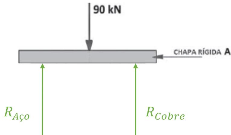
$$\sum F_y = 0 \Rightarrow R_{aço} + R_{cobre} = F = 90000 \text{ N}$$
