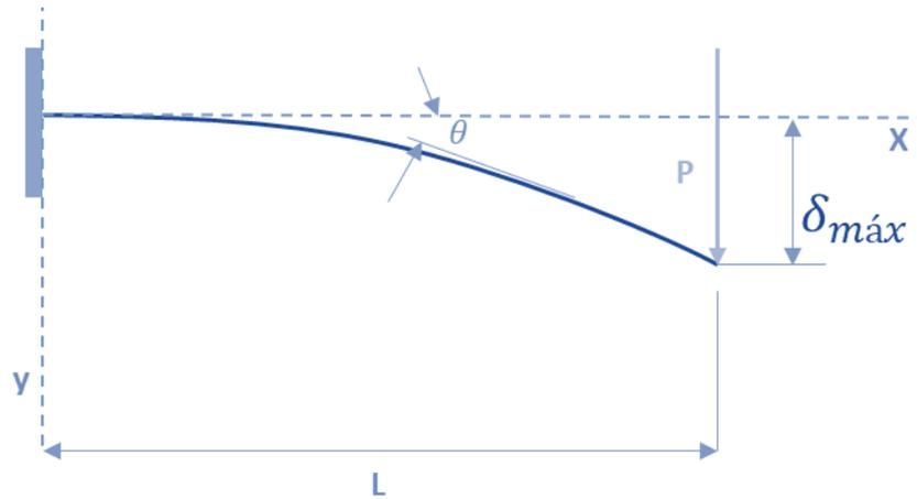
A obtenção das **equações para deflexão** em vigas é realizado através da **integração de equações diferenciais** que descrevem a curva da linha elástica da viga. Quando abordamos vigas com pequenos ângulos de rotação, que são aquelas encontradas em edifícios, automóveis, aeronaves... a curva de deflexão é muito pequena e assim sua **curvatura (k)** pode ser dada por:
