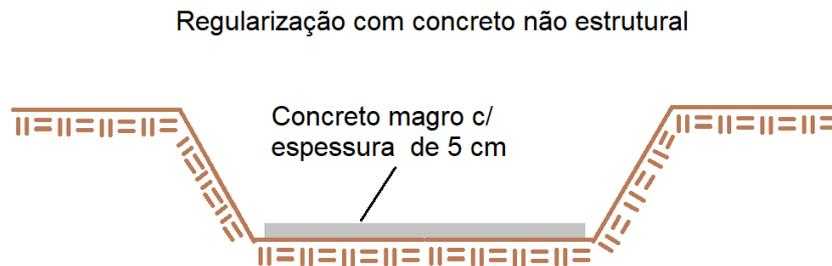
Figura 16: Lançamento do concreto de regularização.
