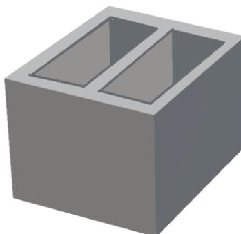
Figura 9: Esquema de fundação profunda do tipo caixão.
