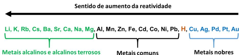
A reação que ocorre ao mergulharmos uma placa de zinco (Zn) em uma solução de sulfato de cobre (CuSO<sub>4</sub>) é um bom exemplo da reação de deslocamento.
