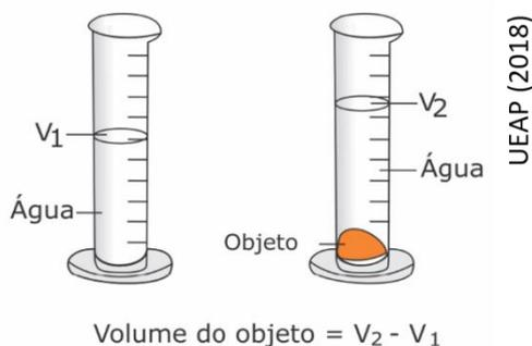
A massa (m) da pedra pode ser pesada em uma balança analítica e a densidade obtida pela relação  $m/V$ .
