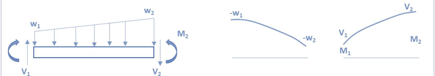
Inclinação negativa para a força cortante e inclinação positiva para o momento fletor.
