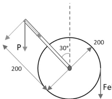
Neste caso o somatório dos momentos causados entre componente perpendicular a polia ( $P \cdot \sin 30^\circ$ ) e a força elástica ( $F_{el}$ ) da mola deve ser igual a zero. Assim obtemos:
