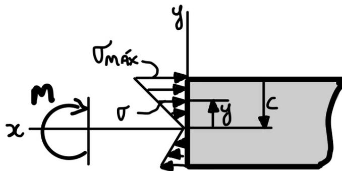
Analogamente para se determinar a tensão normal a uma distância intermediária ( $\gamma$ ), podemos calcular esta a partir da seguinte equação:
