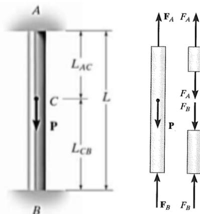
Vamos exemplificar o princípio da superposição com um exemplo em que um elemento estaticamente indeterminado carregado com uma carga axial. Neste caso a barra está presa em ambas as extremidades se tornando indeterminada, pois não é possível a determinação de suas reações através dos princípios de equilíbrio. Vejamos o DCL, ao lado, e a análise de equilíbrio:
