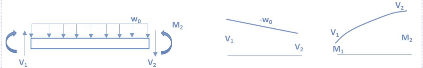
Inclinação negativa constante no diagrama de V e inclinação positiva para o momento fletor.
