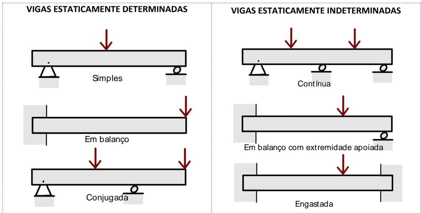
Basicamente, as vigas que se encontram apoiadas, de maneira que podemos calcular as reações aos seus apoios externos aplicando somente os métodos da estática (equações de equilíbrio), são chamadas de vigas estaticamente determinadas. Vigas que possuem mais pontos de apoios do que o necessário para que
