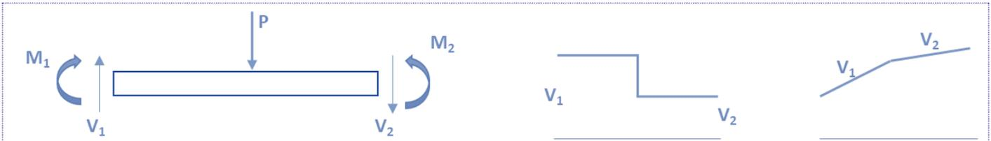
A força P para baixo faz a força cortante V saltar de  $V_1$  para  $V_2$ . No diagrama de momento a inclinação constante muda de  $V_1$  para  $V_2$
