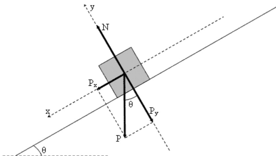
Note que é bem melhor trabalharmos com o movimento do corpo na direção do plano e na direção perpendicular ao plano, pois o movimento do bloco se dá na direção paralela ao plano. Seria uma tarefa nada agradável trabalhar sem decompor os vetores, na direção horizontal e vertical.
