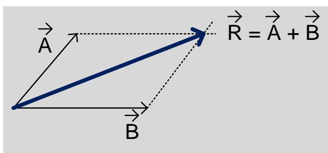
O método do paralelogramo é muito eficiente quando desejamos obter a resultante entre **DOIS** vetores
