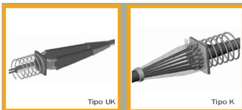
**Ancoragens intermediárias:** são ancoragens posicionadas no meio dos cabos, quando suas extremidades forem inacessíveis para a protensão.
