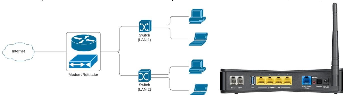
Um roteador pode ser com fio ou sem fio (wireless). Atualmente, a maioria dos roteadores do mercado são sem fio – apesar de permitirem conexão cabeada também. Nós já sabemos que um roteador é capaz de interligar redes diferentes. **No entanto, um roteador wireless é um dispositivo mais flexível, podendo trabalhar em outros três modos diferentes: Hotspot, Access Point ou Repetidor de Sinal.** Vamos falar sobre cada um deles...
