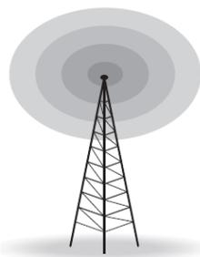
**Trata-se da tecnologia que permite o acesso à internet banda larga via radiofrequência.** As ondas de rádio, em sua maior parte, são omnidirecionais, isto é, quando uma antena transmite ondas de rádio, elas se propagam em todas as direções em broadcast. Elas podem percorrer grandes distâncias e podem atravessar paredes, não necessitando que antenas transmissoras estejam completamente alinhadas. No entanto, não pode haver grandes obstáculos entre o emissor e o receptor de sinal, como montanhas.
