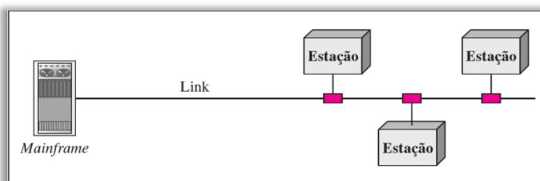
**Já uma conexão ponto-multiponto é uma conexão na qual mais de dois dispositivos compartilham um único link.** E em ambiente multiponto, a capacidade do canal de comunicação é compartilhada, seja de forma espacial ou seja de forma temporal. Se diversos dispositivos puderem usar o link simultaneamente, ele é chamado de conexão compartilhada espacialmente. Se os usuários tiverem de se revezar entre si, trata-se de uma conexão compartilhada no tempo.
