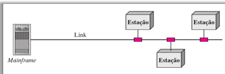
**Já uma conexão ponto-multiponto é uma conexão na qual mais de dois dispositivos compartilham um único link.** E em um ambiente multiponto, a capacidade do canal de comunicação
