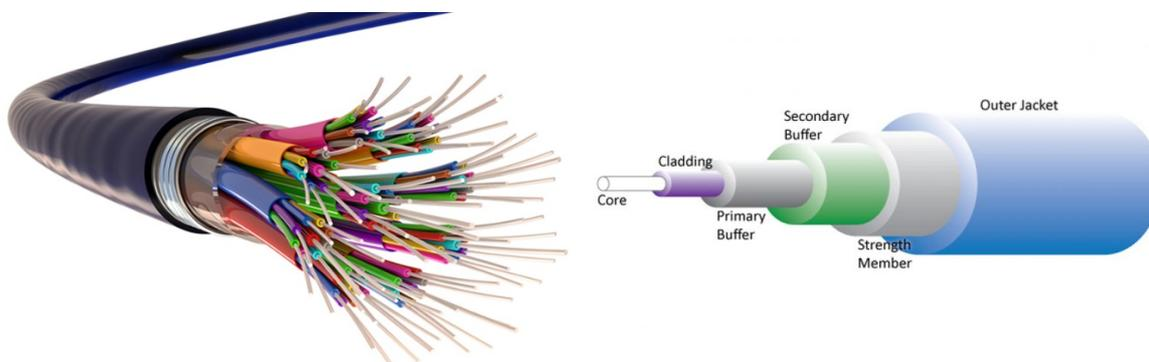
Consiste em uma Casca e um Núcleo (em geral, de vidro) para transmissão de luz. Possui capacidade de transmissão virtualmente infinita, é imune a interferências eletromagnéticas e consegue ligar distâncias maiores sem a necessidade de repetidores. Como desvantagens, ele é incapaz de fazer curvas acentuadas, além de ter um custo de instalação e manutenção muito alto em relação ao par trançado. Entendido? Há dois tipos de fibra: **Monomodo e Multimodo**.
