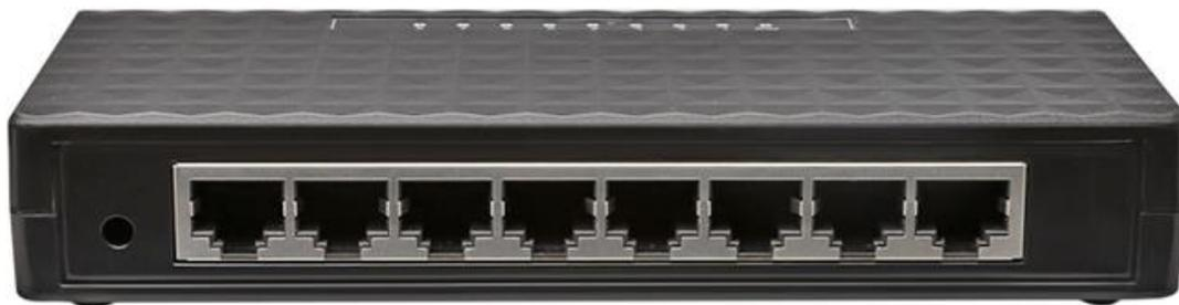
Inicialmente, é importante saber que existem hubs ativos e passivos. **Um hub passivo é simplesmente um conector que concentra e conecta os cabos provenientes de diferentes ramificações. Esse dispositivo sequer é conectado na rede elétrica, portanto não é capaz de regenerar sinais digitais.** Pessoal, se uma questão não mencionar o tipo de hub, podemos assumir que ela está tratando de hubs ativos. Vamos estudá-lo com um pouco mais de detalhes...
