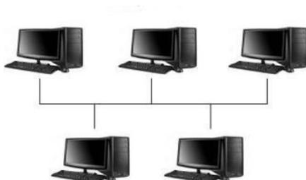
A figura acima mostra uma topologia típica de uma rede industrial de comunicação onde todos os dispositivos compartilham o mesmo meio físico de comunicação. O controle pode ser centralizado ou distribuído. Além de possuir alto poder de expansão, nós com falha não prejudicam necessariamente os demais. Qual a topologia descrita?
