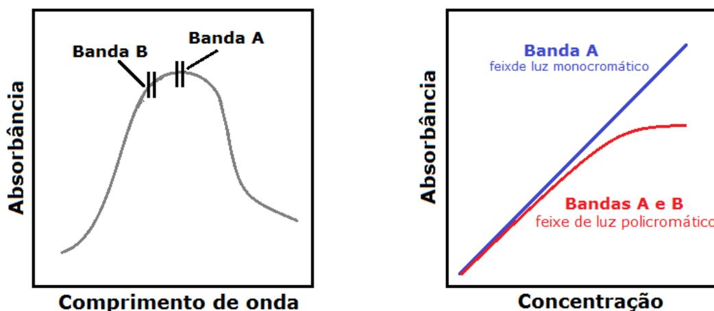
**Luz espúria:** é a radiação fora do comprimento de onda escolhido para análise. Essa radiação indesejada é oriunda de reflexões dos componentes ópticos do equipamento (redes de difração, lentes, espelhos, filtros ou janelas). Se a luz espúria, que é um interferente, estiver presente, então chegará mais luz no detector, provocando uma diminuição na absorbância. Ou seja, a absorbância aparente (observada) será menor que a absorbância real.
