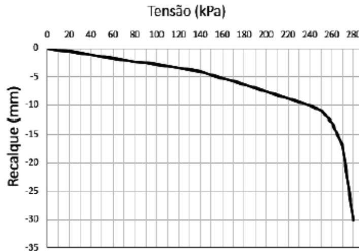
Figura 1 – Curva tensão-recalque
