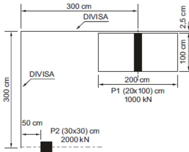
No dimensionamento da fundação direta para o pilar P2 de dimensões 30 cm × 30 cm, com carga de 2000 kN, a sapata mais indicada, distanciada de 2,5 cm da divisa, é
