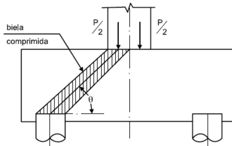
Uma das características do comportamento estrutural desses blocos é que a força transmitida do pilar para as estacas se faz essencialmente por bielas de compressão. Se o ângulo de inclinação das bielas for  $30^\circ$ , a força de compressão resultante em cada biela é
