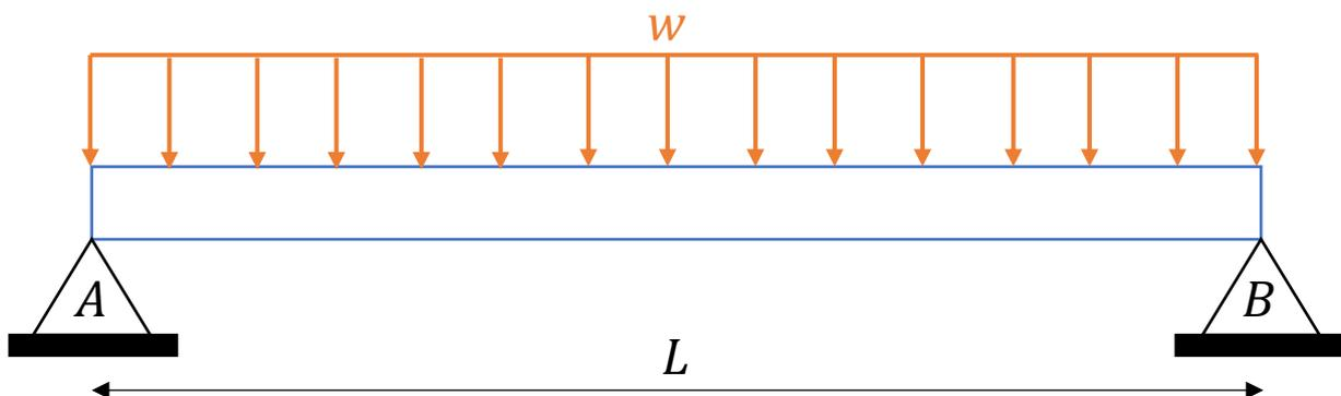
Caro(a) aluno(a). Vigas biapoiadas submetidas a um carregamento distribuído simetricamente ao longo de seu comprimento apresentam o momento fletor máximo no centro da viga. Isso ocorre justamente pela simetria da estrutura e dos carregamentos. Este tipo de apoio
