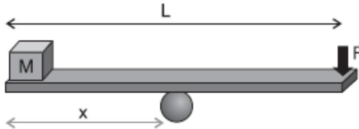
Uma prancha de madeira de massa desprezível e comprimento  $L = 2,8$  m é utilizada para manter em equilíbrio, na horizontal, um cubo pequeno de massa  $20,0$  kg ao realizar uma força  $F$  de  $80,0$  N em uma das extremidades da prancha.
