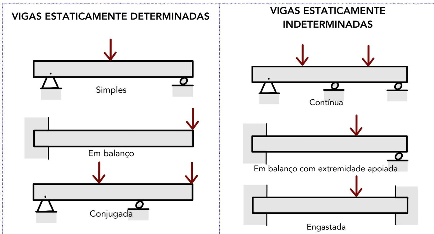
Podemos também identificar as vigas pelos **tipos de carregamentos externos** a qual estão expostas. Estas podem sofrer cargas concentradas, como vistas na figura acima ou distribuídas, conforme a figura abaixo.
