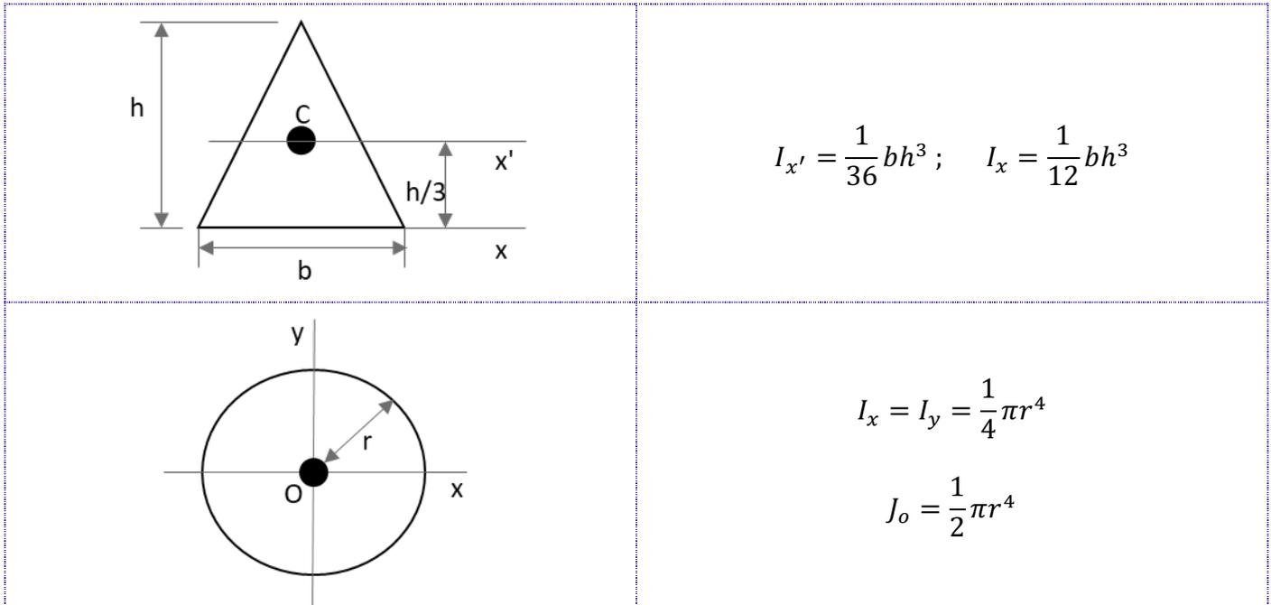
Se o momento de inércia de uma área situada em torno de um eixo centroide for conhecido, é possível determinar o momento de inércia da área em torno de um **eixo paralelo** correspondente através do **TEOREMA DOS EIXOS PARALELOS**. Esse teorema é muito utilizado na hora de calcularmos o momento de inércia de **áreas compostas**. As equações que definem o teorema dos eixos paralelos são:
