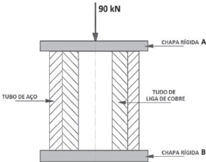
Sabendo que os dois tubos têm áreas da seção transversal resistente iguais e que o módulo de elasticidade do aço é igual ao dobro do módulo de elasticidade da liga de cobre, as intensidades das cargas, em kN, suportadas pelo tubo de aço e pelo tubo de liga de cobre são, respectivamente:
