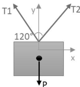
As **forças trativas**  $T_1$  e  $T_2$  são **opostas** logo suas componentes em X se anulam. As componentes do eixo Y das cordas é que sustentam a caixa e formam um ângulo de  $60^\circ$  com o eixo y imaginário que corta o centro da caixa. Por fim, aplicando as equações de equilíbrio, sabendo que as forças  $T_1$  e  $T_2$  são iguais e, que a força peso é igual a massa multiplicada pela aceleração da gravidade, obtemos:
