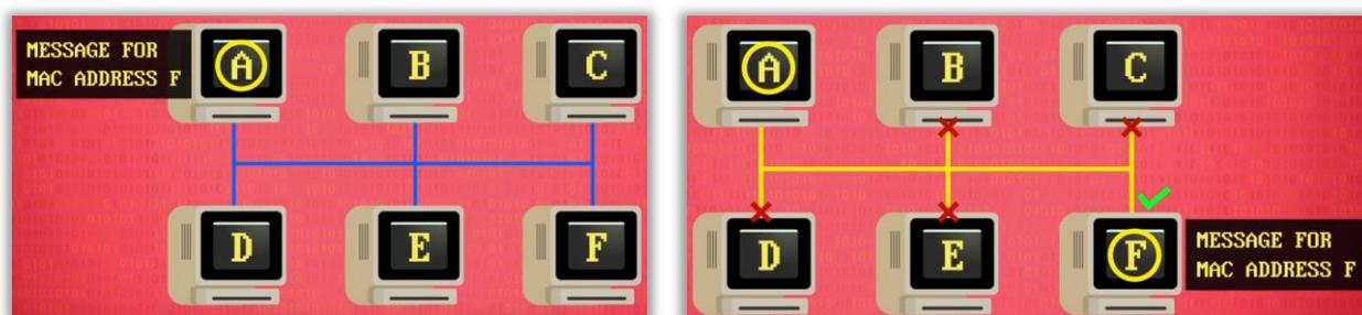
O termo genérico para essa abordagem vista acima é **Carrier Sense Multiple Access (CSMA)**, também conhecido como **Acesso Múltiplo com Detecção de Portadora**. Em outras palavras, trata-se de um protocolo utilizado na Ethernet para monitorar o meio de transmissão e evitar colisões quando ocorrem múltiplos acessos. Nós já estudamos esse problema no tópico de topologia em barramento, mas agora vamos detalhar um pouco mais.
