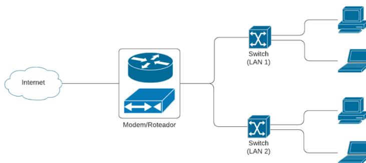
Um roteador pode ser com fio ou sem fio (wireless). Atualmente, a maioria dos roteadores do mercado são sem fio – apesar de permitirem conexão cabeada também. Nós já sabemos que um roteador é capaz de interligar redes diferentes. **No entanto, um roteador wireless é um dispositivo mais flexível, podendo trabalhar em outros três modos diferentes: Hotspot, Access Point ou Repetidor de Sinal.** Vamos falar sobre cada um deles...
