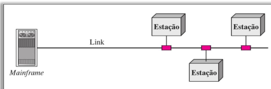
**Já uma conexão ponto-multiponto é uma conexão na qual mais de dois dispositivos compartilham um único link.** E em ambiente multiponto, a capacidade do canal de comunicação
