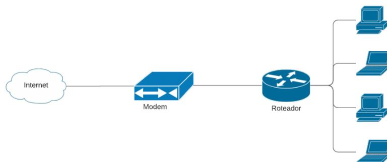
**Atualmente, nós estamos na era dos combos, isto é, um único provedor fornece Internet, Telefone e TV a Cabo (Ex: NET/Claro, GVT/Vivo, etc).** Nesse caso, um único aparelho condensa as funções de modem e roteador – você provavelmente tem esse aparelho na sua casa! Em geral, um cabo coaxial branco entra nesse dispositivo, que possui geralmente quatro portas. Em empresas, nós temos geralmente uma configuração um pouco diferente.
