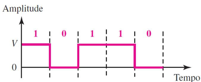
A Codificação NRZ (Non-Return to Zero) é extremamente simples: para representar o bit 1, utilizamos a voltagem positiva; e para representar o bit zero, utilizamos uma voltagem zero. Vejam na imagem ao lado que **sinal alto é representado por 1 e sinal baixo é representado por 0, gerando como resultado 10110.**
