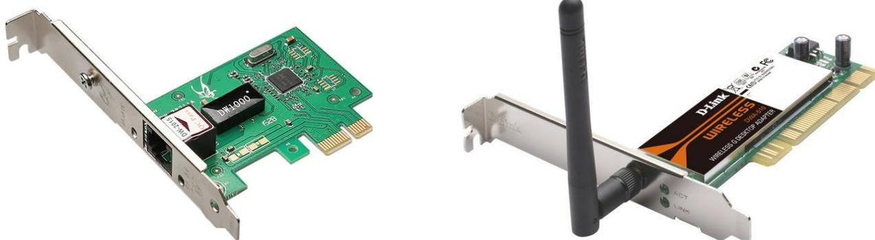
**Galera, essa é a famosa Placa de Rede<sup>4</sup>!** Se vocês olharem na parte de trás do gabinete de um computador, vocês a verão (provavelmente com o cabo azul de par trançado conectado a ela). Esse é o recurso de hardware geralmente instalado no computador para permitir uma comunicação bidirecional – transmissão e recebimento de dados – com os demais elementos da rede. Agora vejam que coisa interessante...
