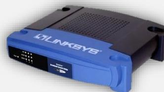
Equipamento capaz de separar uma rede em segmentos menores, reduzindo as chances de colisões quando várias máquinas desejam transmitir dados ao mesmo tempo. São dispositivos capazes de enviar dados para máquinas específicas.
