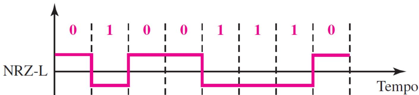
Antes disso, veremos a Codificação NRZ-L (Non-Return to Zero Level). Nessa codificação, para representar o bit 1, utilizamos uma voltagem negativa; e para representar o bit 0, utilizamos uma voltagem positiva (utilizando os polos acima e abaixo do eixo do tempo). **Vejam na imagem ao acima que sinal baixo é representado por 1 e sinal alto é representado por zero, gerando como resultado 01001110.** E agora veremos a Codificação Manchester...
