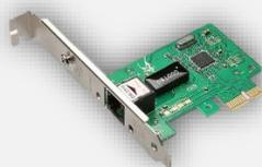
Equipamento de rede de comunicação bidirecional (entrada e saída de dados) conectado à placa-mãe do computador. Toda placa de rede possui um número identificador chamado Endereço MAC (48 Bits).
