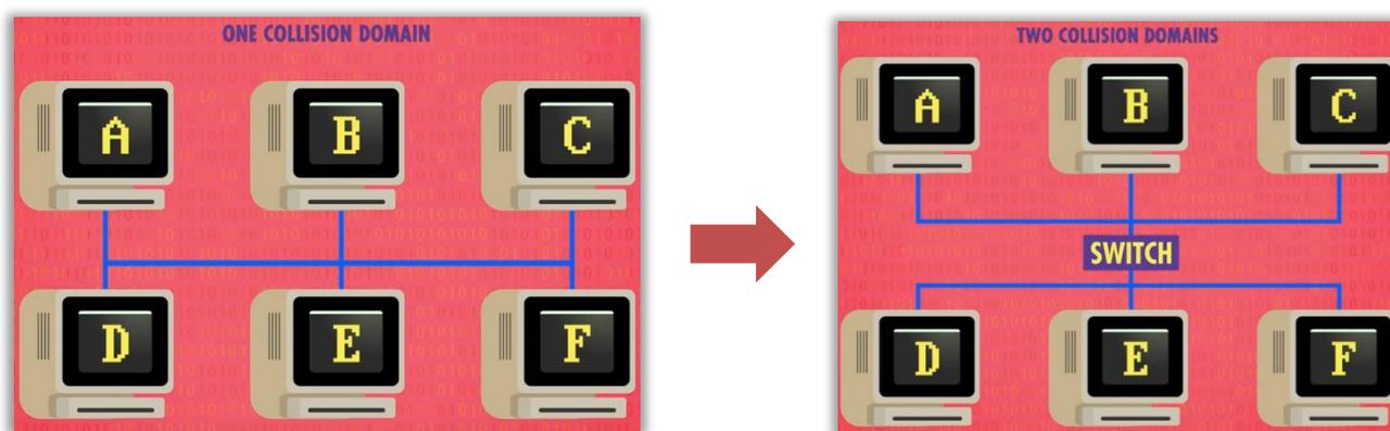
**Para tal, podemos utilizar um dispositivo chamado Switch – visto anteriormente. Ele segmentará nossa rede em duas partes e será posicionado entre elas.** Dessa forma, ele só passa dados para o outro domínio de colisão se a mensagem for destinada a algum computador presente nesse domínio de colisão. *Como ele faz isso, professor?* Ele guarda uma lista de Endereços MAC dos computadores de cada rede.
