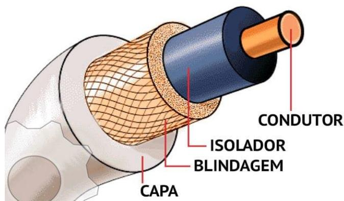
Consiste em um fio central de cobre, envolvido por uma blindagem metálica. Isolantes de plástico flexível separam os condutores internos e externos e outras camadas do revestimento que cobrem a malha externa. Esse meio de transmissão é mais barato, relativamente flexível e muito resistente à interferência eletromagnéticas graças a sua malha de proteção. Esse cabo cobre distâncias maiores que o cabo de par trançado e utiliza um conector chamado BNC.
