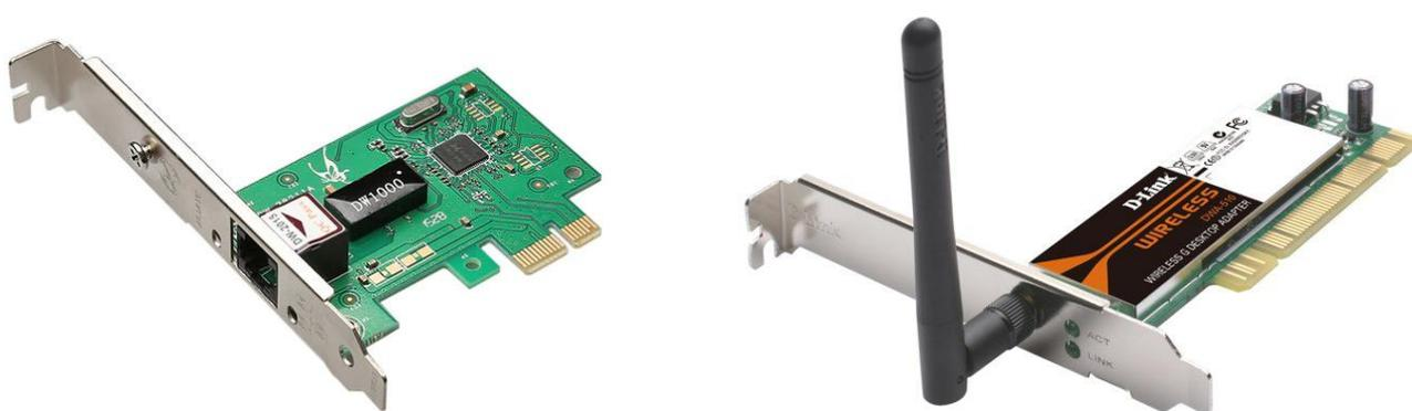
**Galera, essa é a famosa Placa de Rede<sup>4</sup>!** Se vocês olharem na parte de trás do gabinete de um computador, vocês a verão (provavelmente com o cabo azul de par trançado conectado a ela). Esse é o recurso de hardware geralmente instalado no computador para permitir uma comunicação bidirecional – transmissão e recebimento de dados – com os demais elementos da rede. Agora vejam que coisa interessante...
