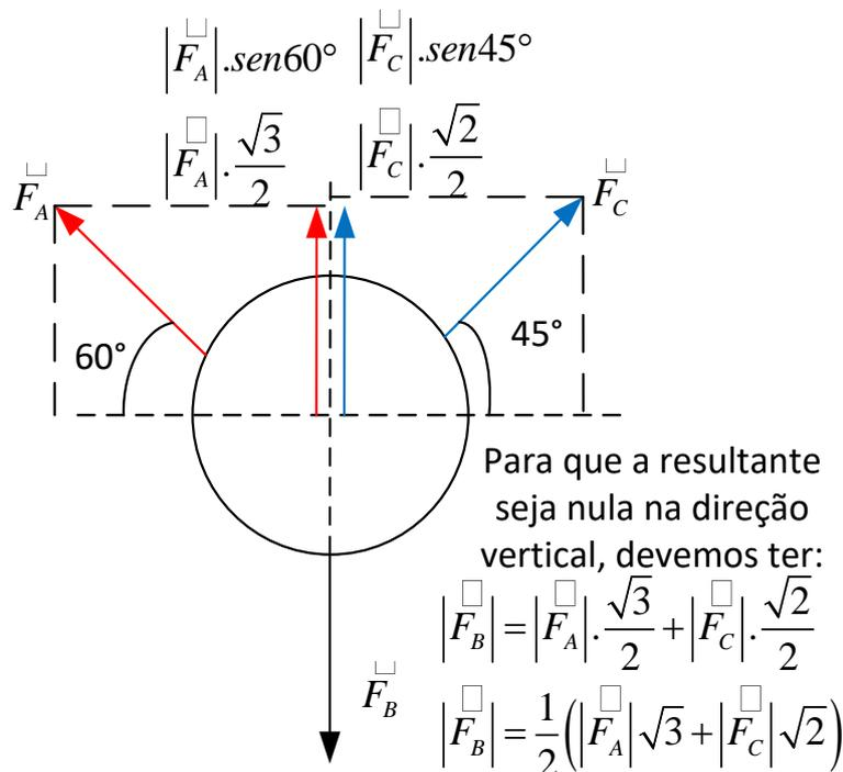
Note que foi feita a decomposição dos vetores  $\vec{F}_A$  e  $\vec{F}_C$ , e depois foi imposta a condição de resultante nula na vertical à roda, que nada mais é do que a força total que puxa a roda para cima deve ser igual à força que puxa a roda para baixo.
