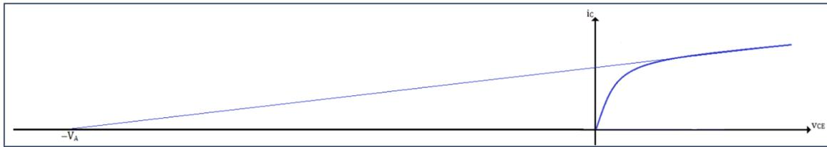
A **corrente de coletor** é praticamente constante em relação a  $v_{CE}$ .
