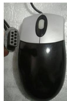
**PS/2:** é um conector mini-DIN de 6 pinos utilizado para conectar teclados e mouses a um sistema de computador compatível com PC. O conector de mouse PS/2 geralmente substitui antigos conectores de
