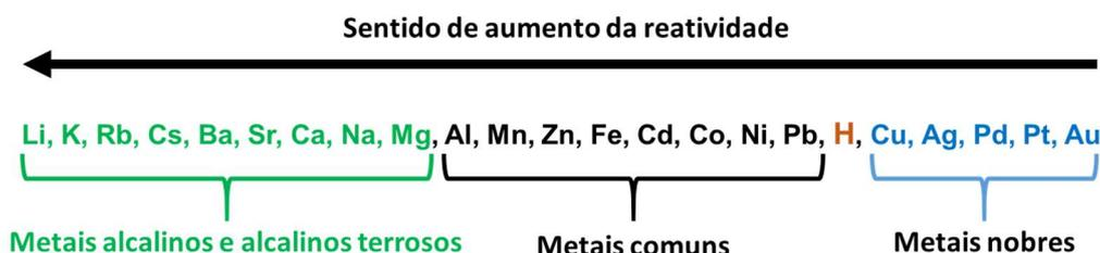
A reação que ocorre ao mergulharmos uma placa de zinco ( $\text{Zn}$ ) em uma solução de sulfato de cobre ( $\text{CuSO}_4$ ) é um bom exemplo da reação de deslocamento.
