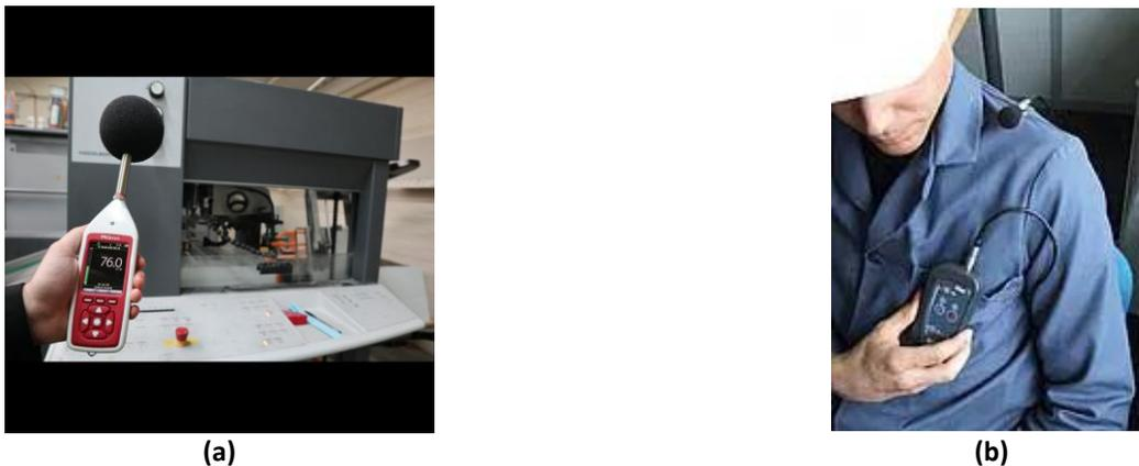
**Figura 2** - (a) modelo comercial de medidores de leitura instantânea portados pelo avaliador, (b) modelo comercial de medidores integradores portados pelo trabalhador
